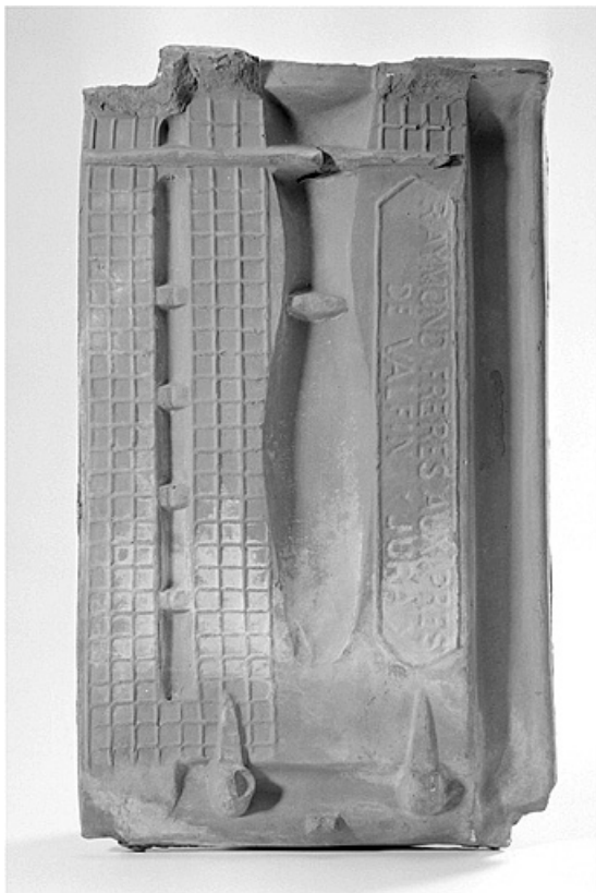
Vue de dessous d'une tuile dite « à la truite ». 39, La Rixouse
