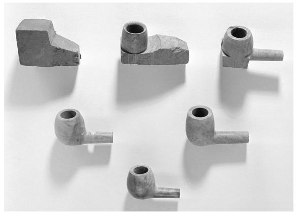
Les différentes phases de fabrication d'une pipe.
