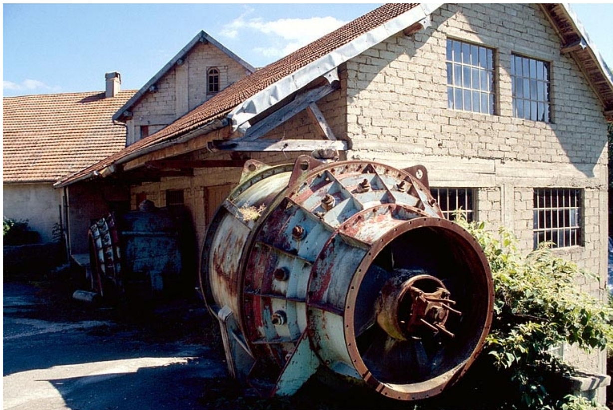
Turbines déposées devant le magasin industriel.
