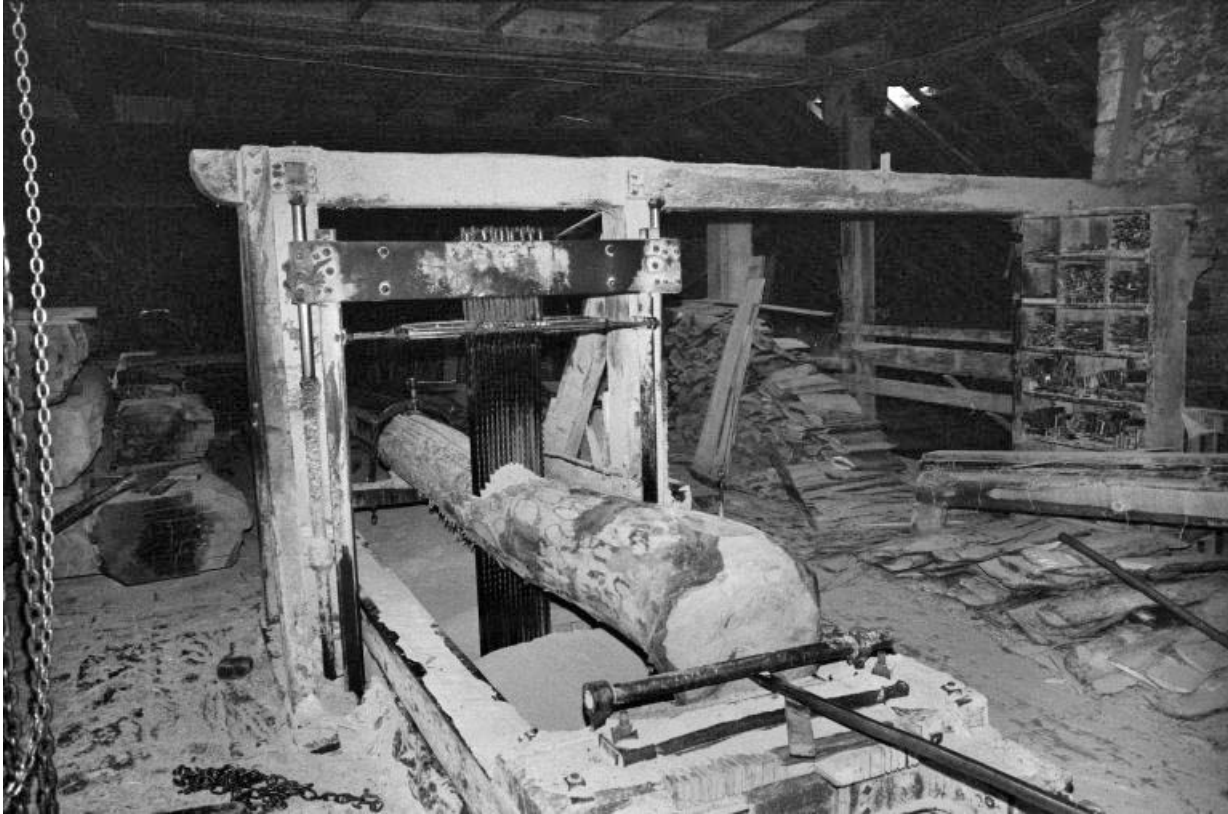
Le châssis de la scie à lames multiples.
