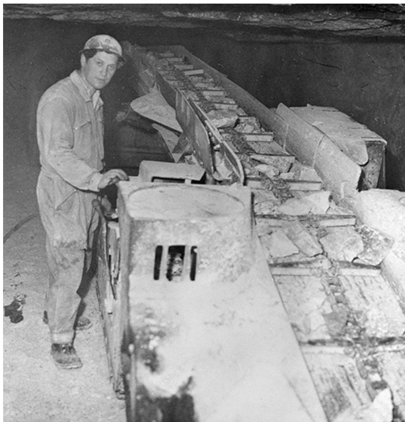
[Chargement des blocs de gypse dans la carrière].
