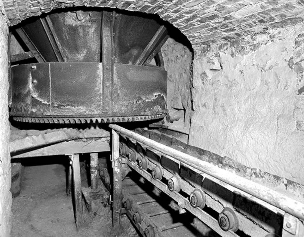
Partie inférieure d'un four à surcuit.Extracteur et convoyeur horizontal.
