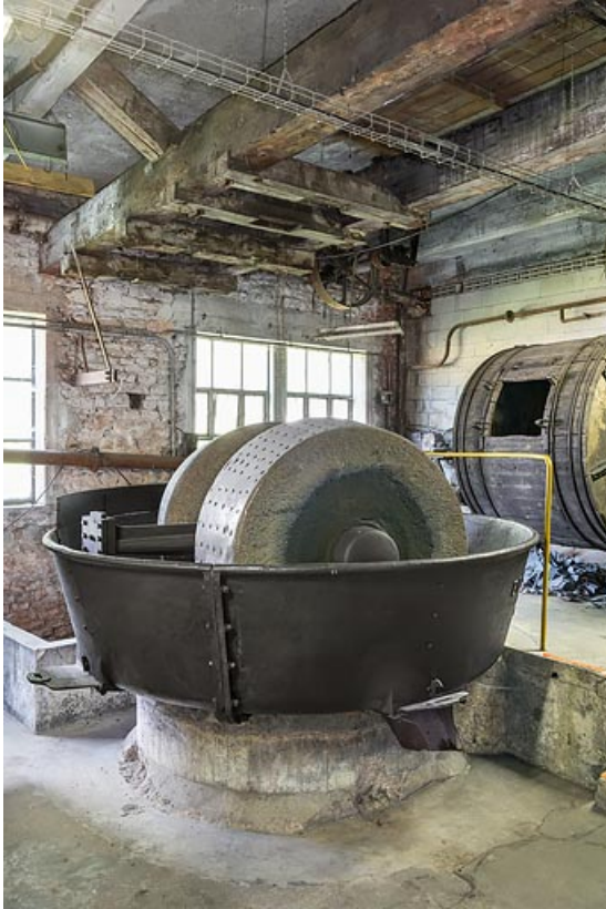
Défibreuse Lamort (cadrage vertical).
