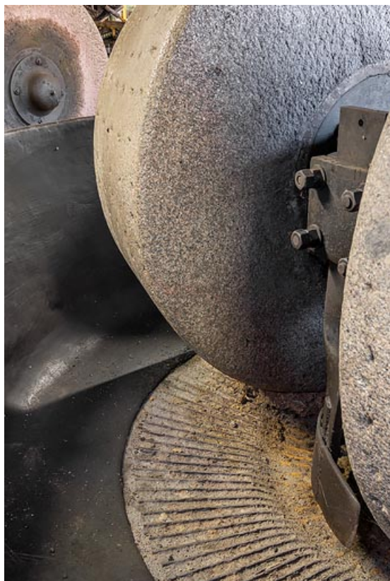
Défibreuse : détail des meules.
