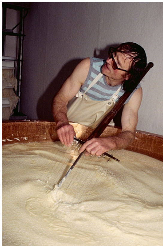
Décaillage au tranche-caillé manuel.
