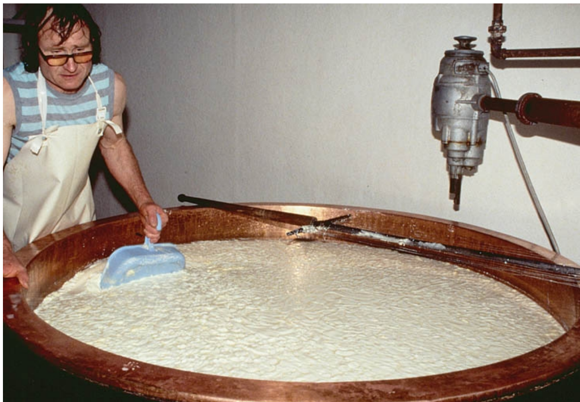
Vérification du décaillage, à la poche. 39, Arthenas
