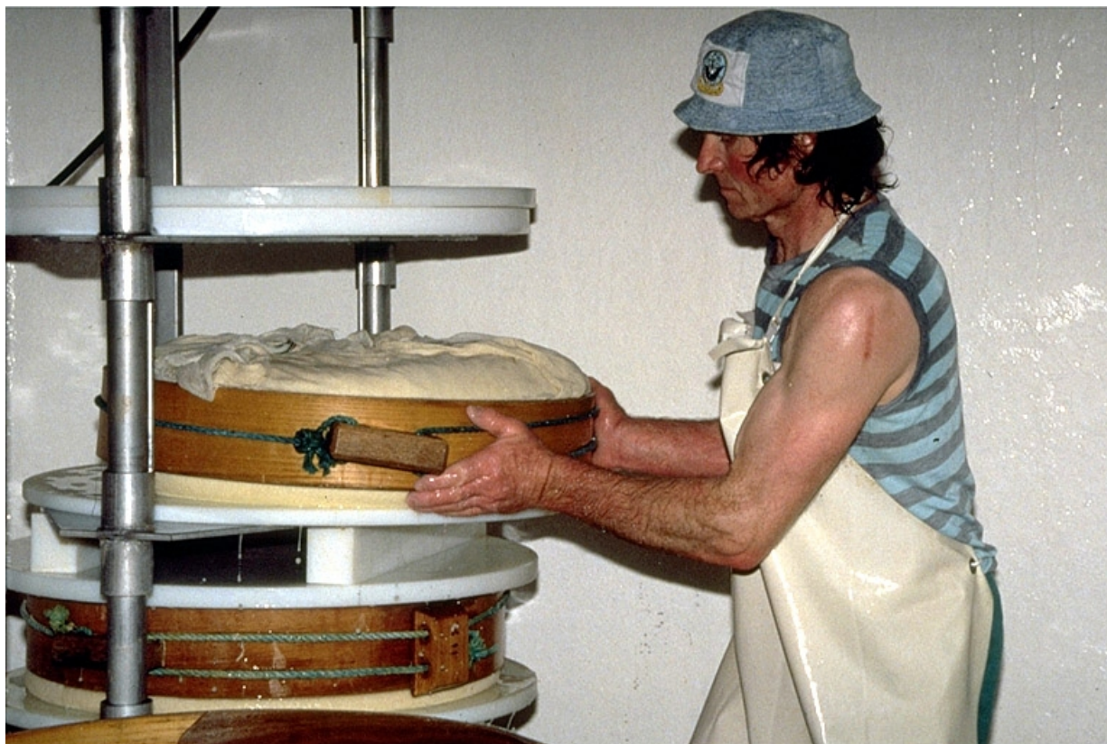
Chargement de la presse pneumatique. 39, Arthenas
