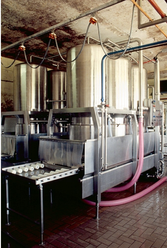
Cloches de l'installation de soutirage sous vide.
