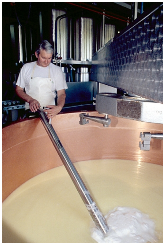
Soutirage sous vide. 39, La Marre 3e fromagerie
