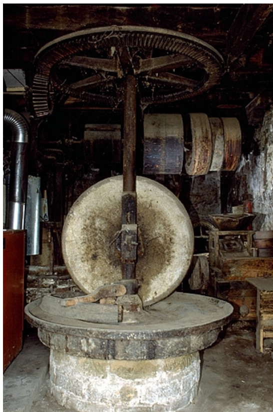
Atelier de fabrication. Au premier plan : meules et transmission.
