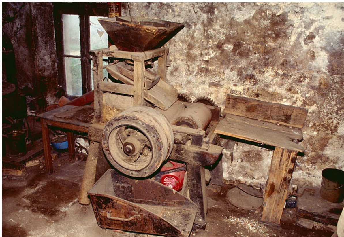
Appareil à cylindres. Cet appareil permet d'écraser les matières oléagineuses.
