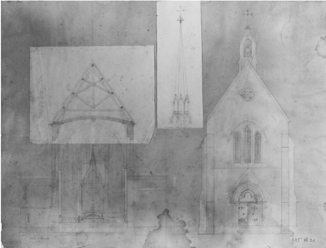
[Projets (?) pour la chapelle de Baudin : élévation du pignon ouest et de la flèche, coupe transversale du choeur].
