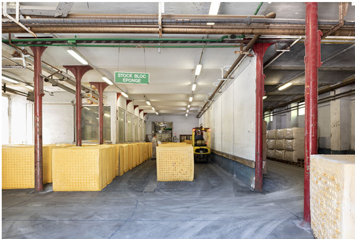
Fabrication : stockage temporaire des blocs juste démoulés.
