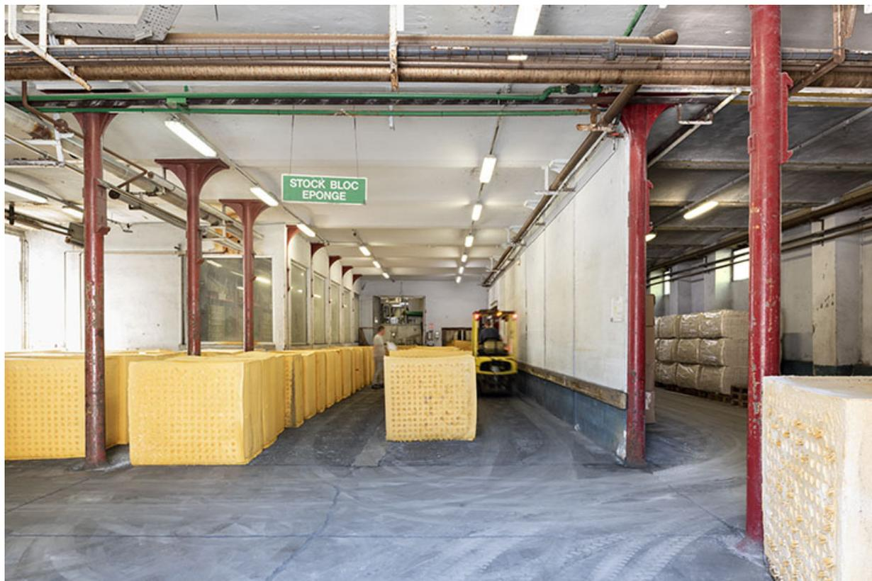
**Fabrication : stockage temporaire des blocs juste démoulés.**
