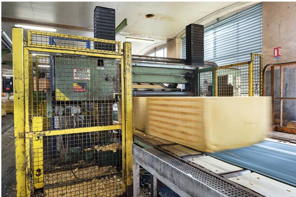
**Fabrication : découpe d'un bloc en plaques.**
