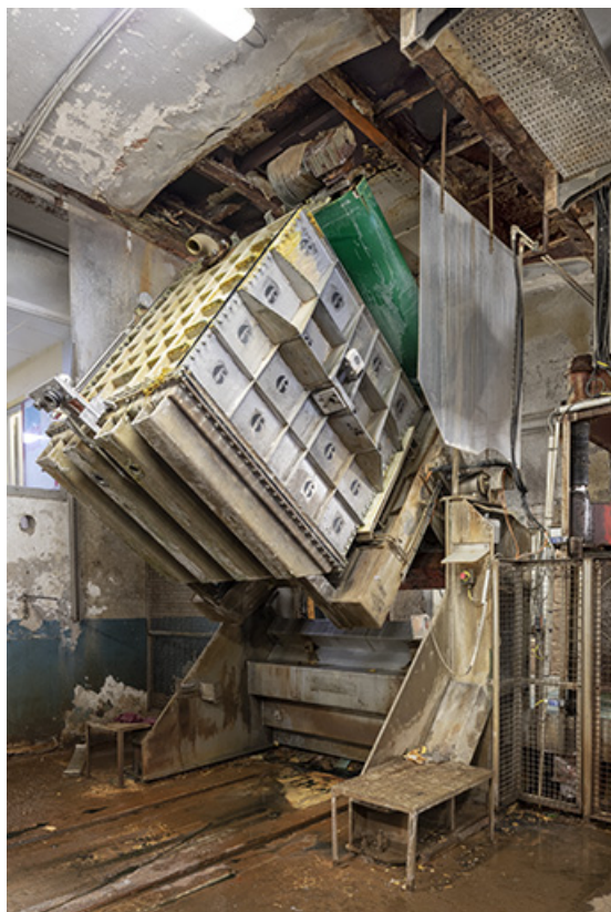
Fabrication : moule en cours de retournement, sur le poste de démoulage.
