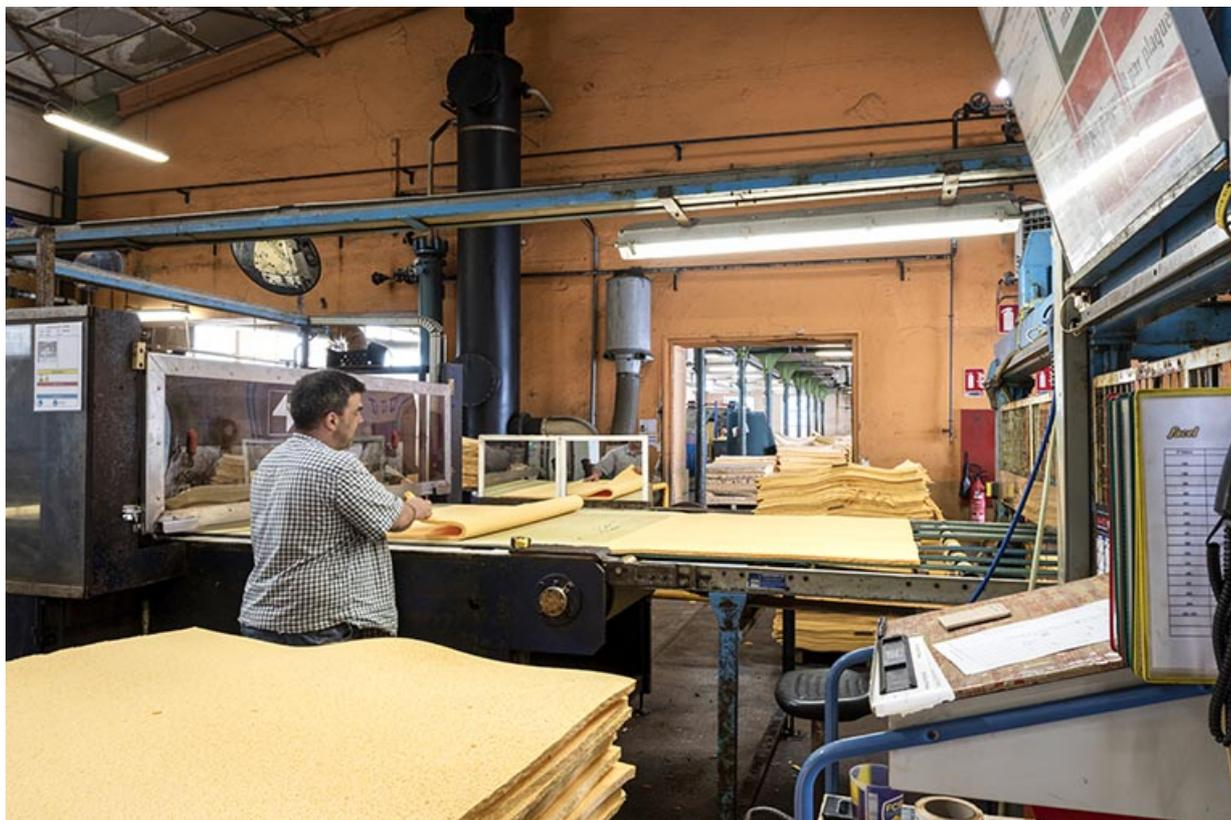
**Fabrication : découpe et contrôle des plaques.**
