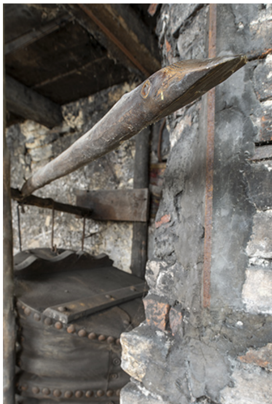
Forge : le soufflet (avec la perche servant à l'actionner). 25, Montécheroux, 1 Grande Rue
