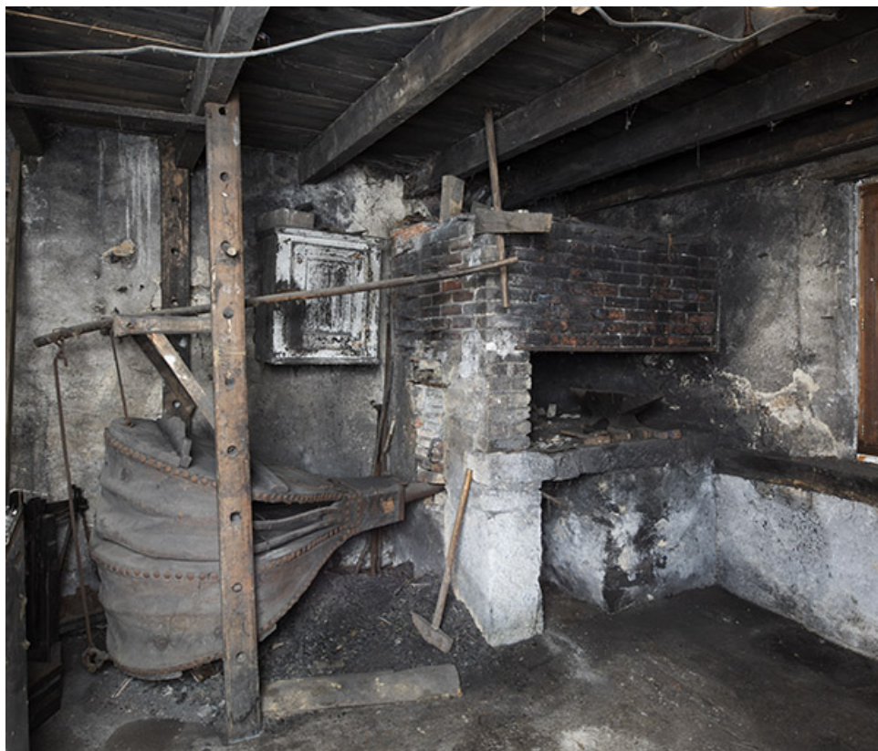
Forge : soufflet, foyer et établi (à droite).
