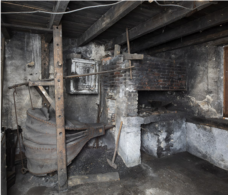
Forge : soufflet, foyer et établi (à droite).
