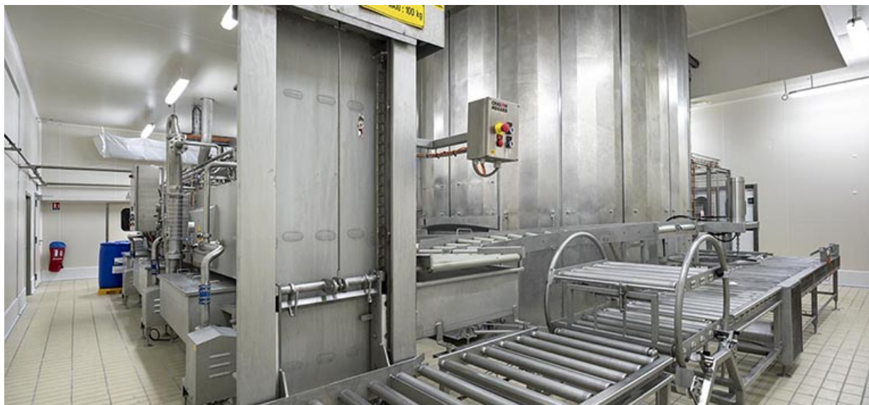
Tour de pressage fermée et convoyeur avec système de retournement. 25, Les Plains-et-Grands-Essarts, 2 rue des Jonquilles
