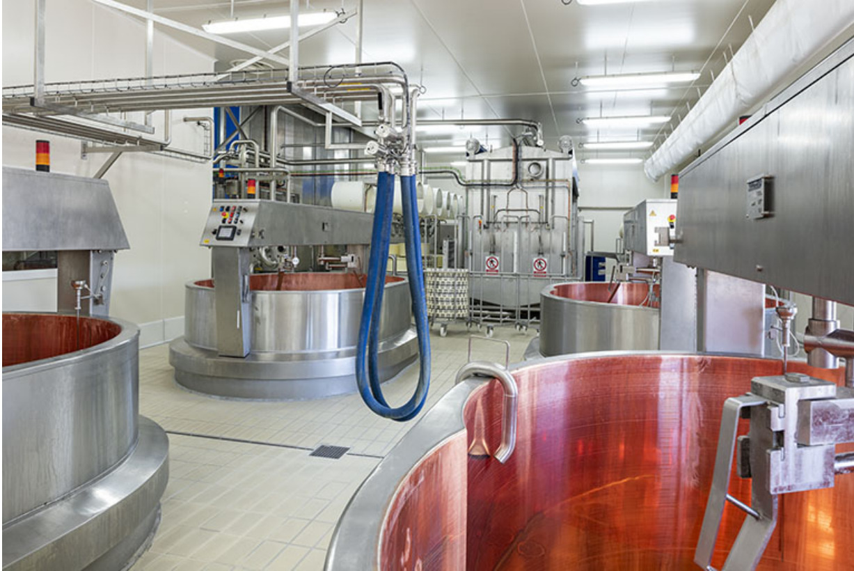
Intérieur de l'atelier de fabrication : cuves, avec l'installation de moulage en arrière-plan.
