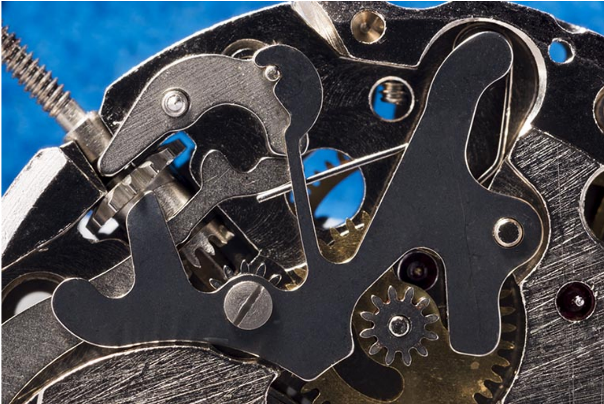
Mouvement de montre mécanique France Ebauches FE 233-68-E-21 : la tirette. 25, Villers-le-Lac
