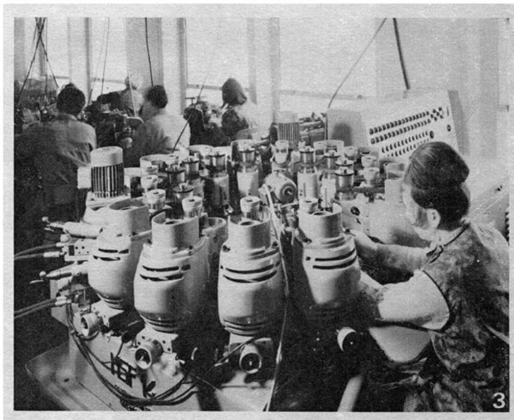
France Ebauches, une haute technicité. 3. Machine transfert 14 postes, réservée à la fabrication du calibre automatique, 1970.
