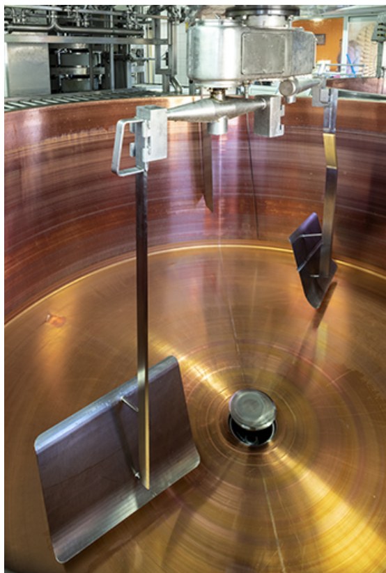
Atelier de fabrication : brassoires à l'intérieur d'une cuve.
