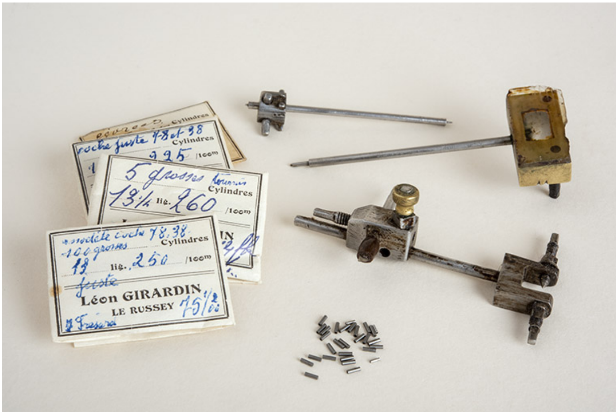
Éléments de machines et paquets de cylindres. Au premier plan au centre : cylindres non encochés.
