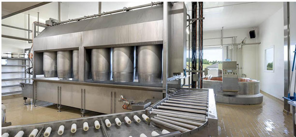
Atelier de fabrication : système de moulage.
