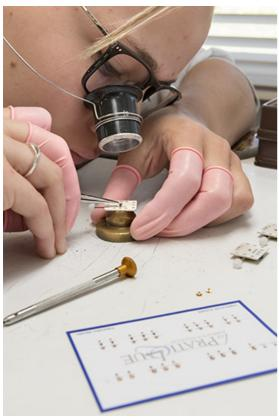
Horlogère à l'établi : pose des aiguilles.
