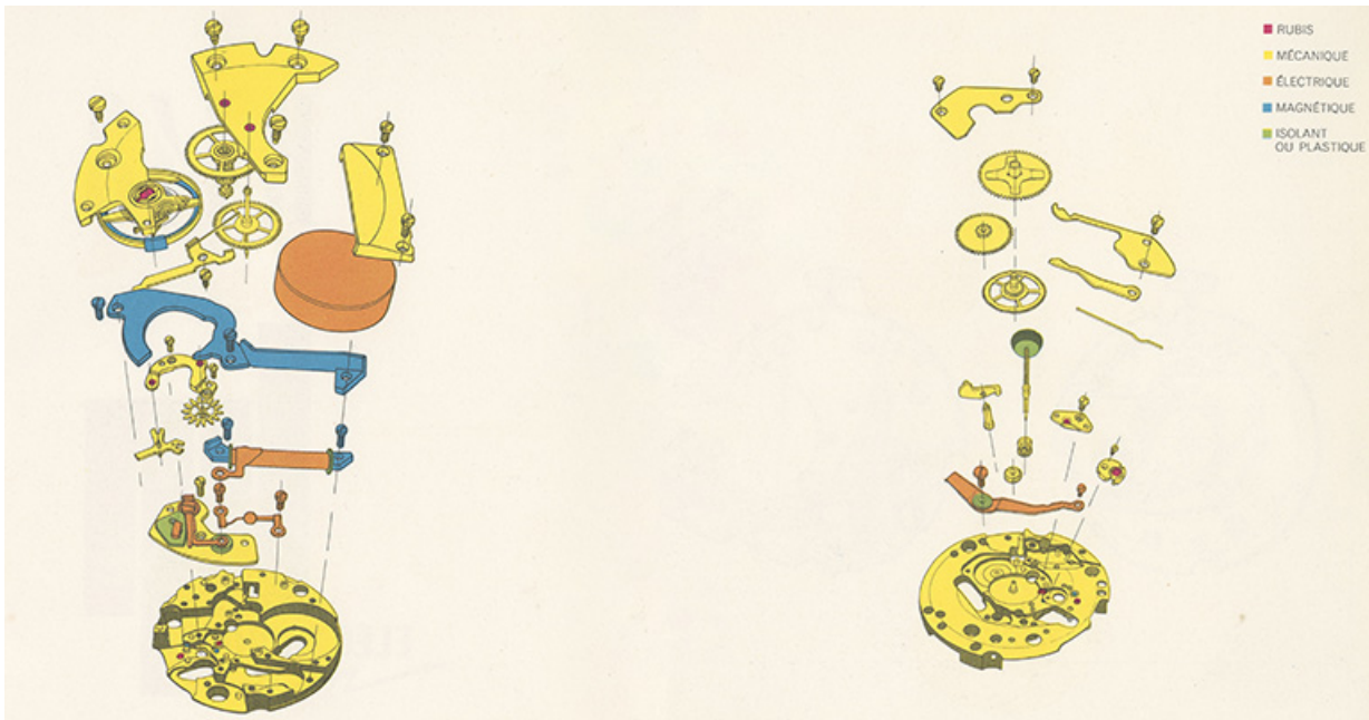
Eclaté d'un mouvement de montre Lip, 1969. 25, Besançon chemin de Palente
