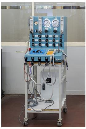
Banc de contrôle pour pièces à main et contres-angle. 25, Besançon, 5, 12 rue du Tunnel
