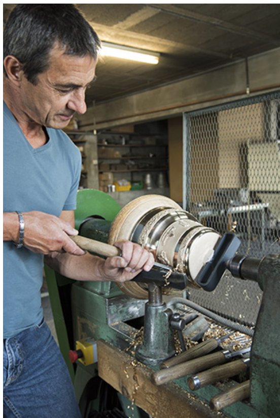
Tournage d'une cloche : geste de l'ouvrier. 25, Les Fins, 4 route de Morteau
