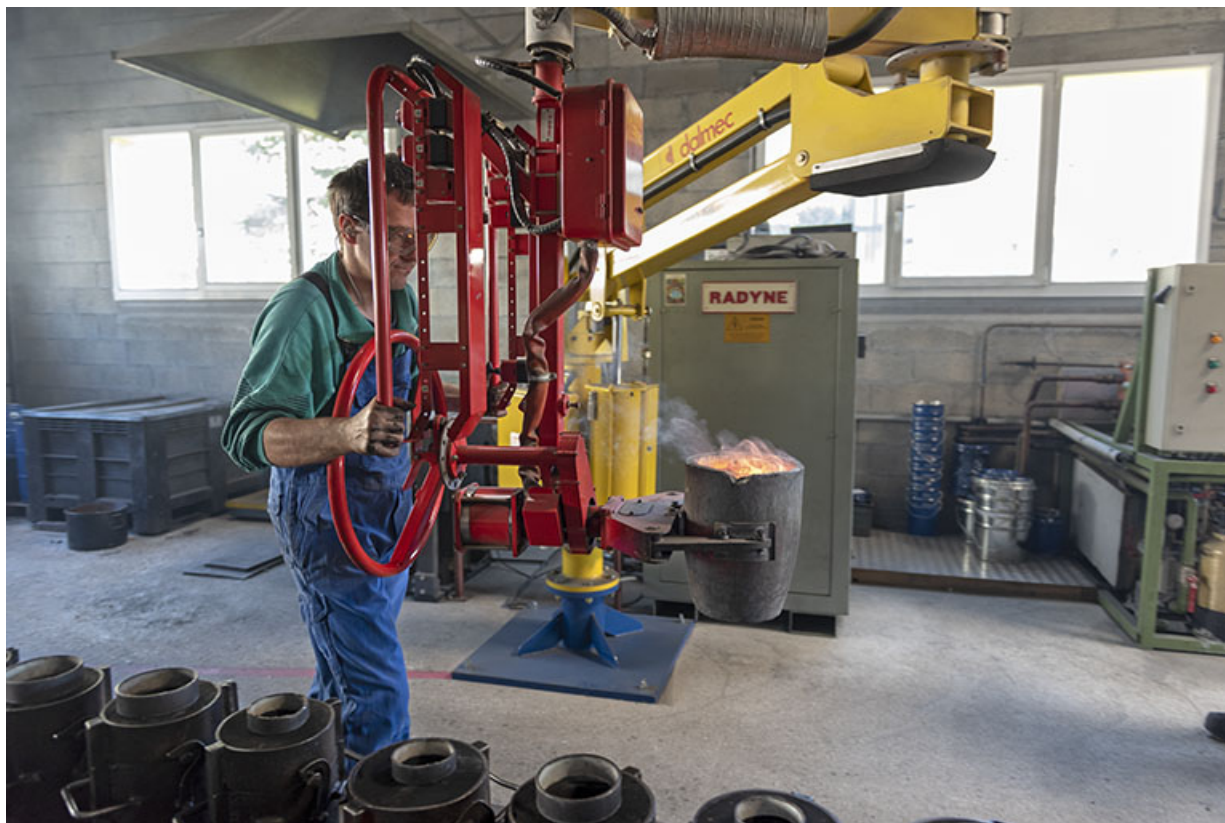
Transport du creuset (poche) plein de bronze en fusion, à l'aide de la grue d'atelier. 25, Les Fins, 4 route de Morteau
