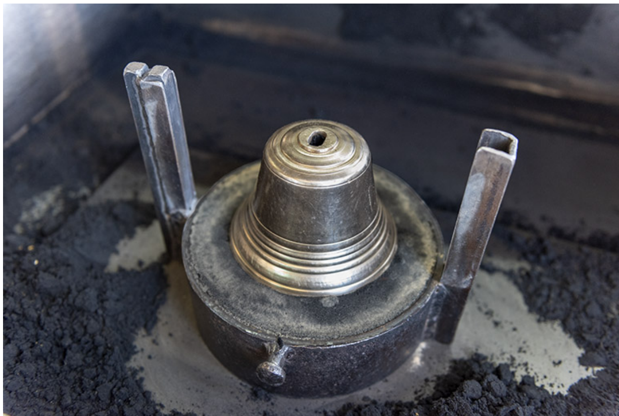
Fabrication du moule : le modèle posé sur le socle du châssis.
