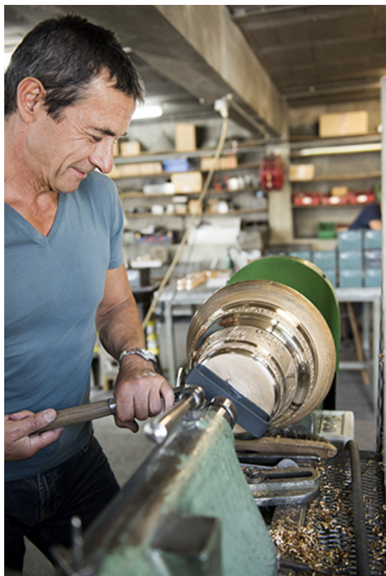
Tournage d'une cloche : geste de l'ouvrier.
