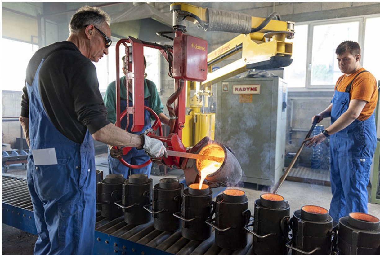
Coulée dans un petit châssis (Yves Obertino éloigne les scories avec une barre métallique). 25, Les Fins, 4 route de Morteau
