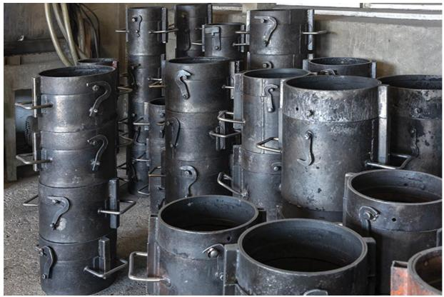
Fabrication du moule : les châssis. 25, Les Fins, 4 route de Morteau
