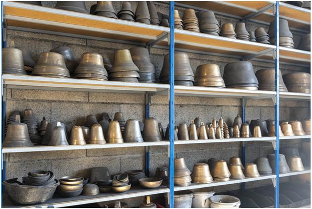
**Fabrication du moule : les modèles.** 25, Les Fins, 4 route de Morteau
