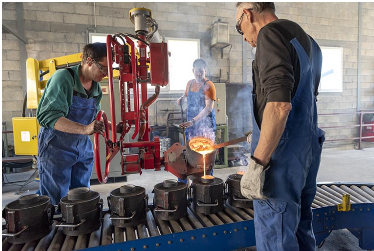
Coulée dans un petit châssis.
