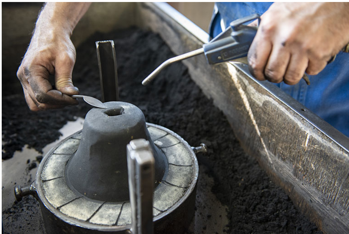
Fabrication du moule : finition du moulage en relief (intérieur de la cloche) une fois le modèle retiré. 25, Les Fins, 4 route de Morteau
