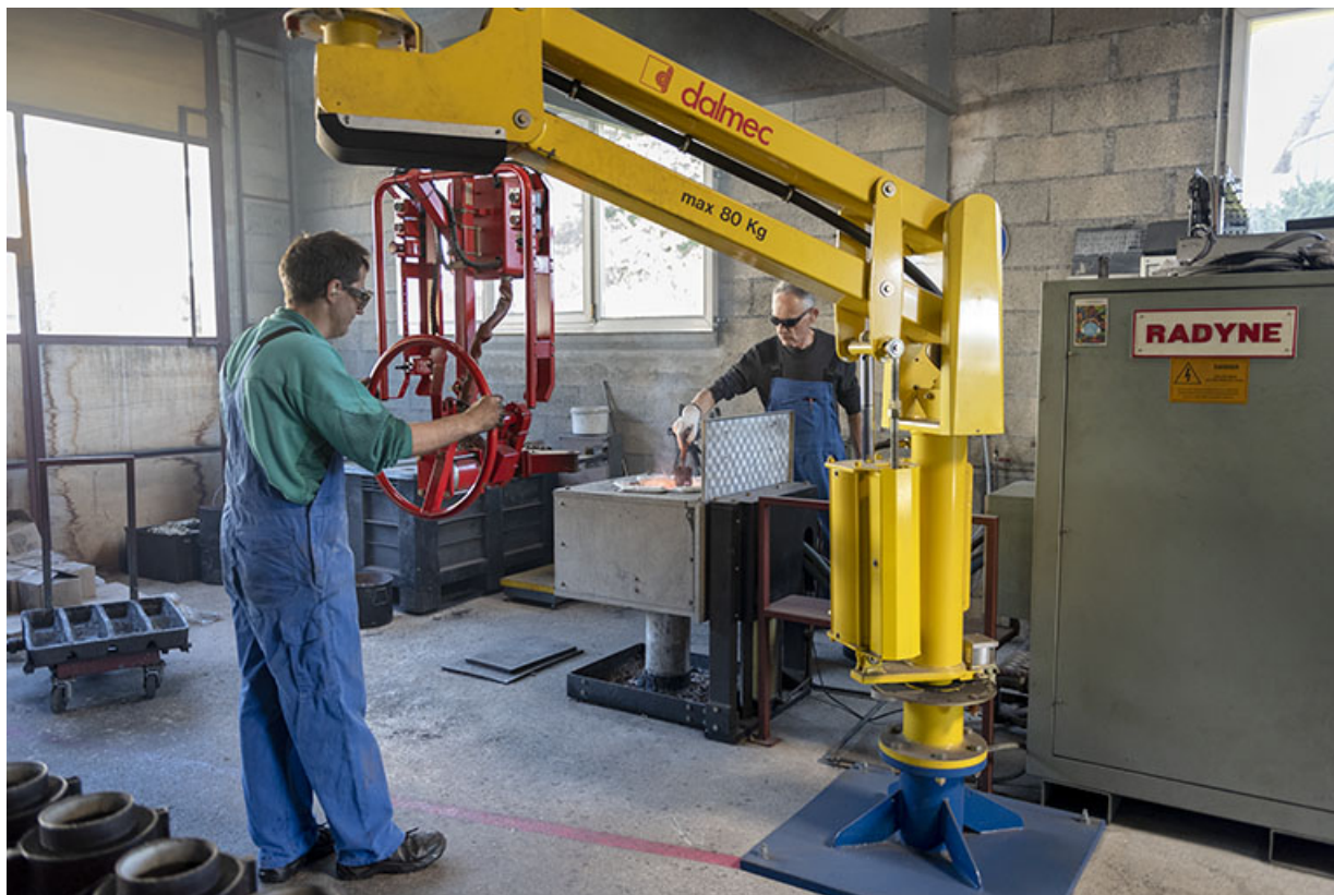
Fonte du bronze (la grue est prête à saisir la poche de métal en fusion). 25, Les Fins, 4 route de Morteau
