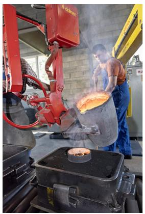
Coulée dans un grand châssis. 25, Les Fins, 4 route de Morteau
