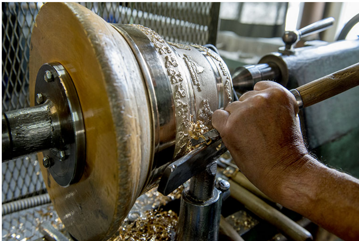
Tournage d'une cloche : position du ciseau. 25, Les Fins, 4 route de Morteau
