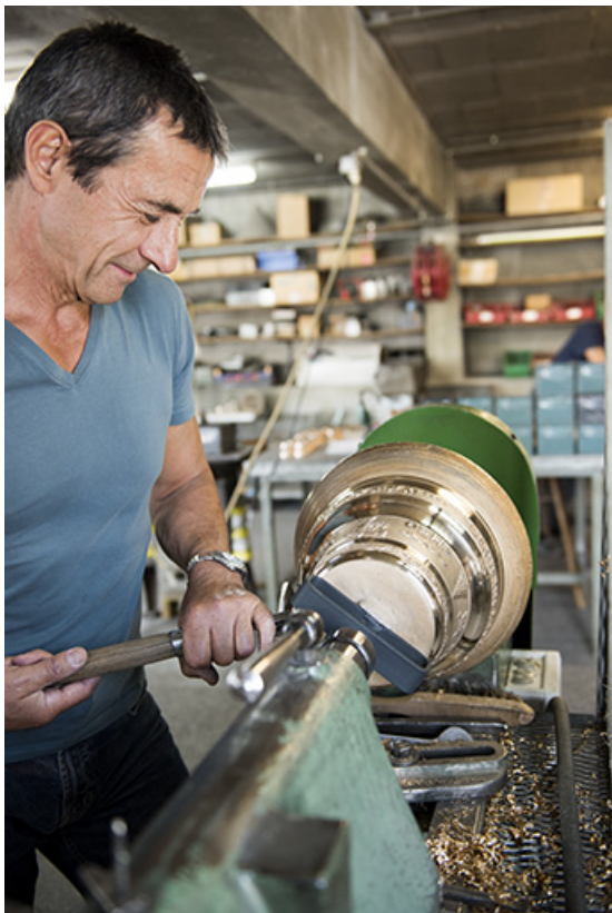
Tournage d'une cloche : geste de l'ouvrier.
