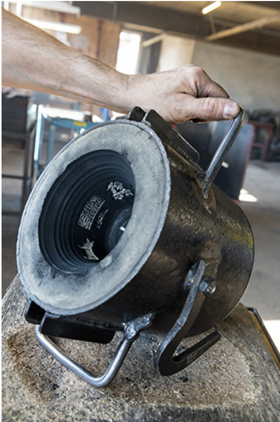
Fabrication du moule : moule en creux avec ses inscriptions et ses décors.
