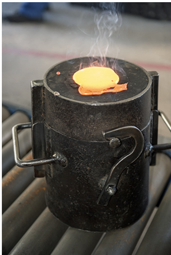
Refroidissement du bronze dans un petit châssis.
