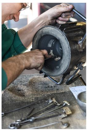
Fabrication du moule : impression de décors dans le moule en creux. 25, Les Fins, 4 route de Morteau
