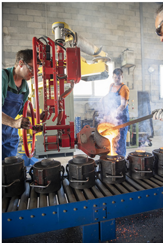
Coulée dans un petit châssis.
