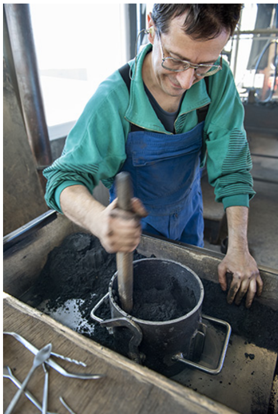
Fabrication du moule : tassage du sable autour du moule.
