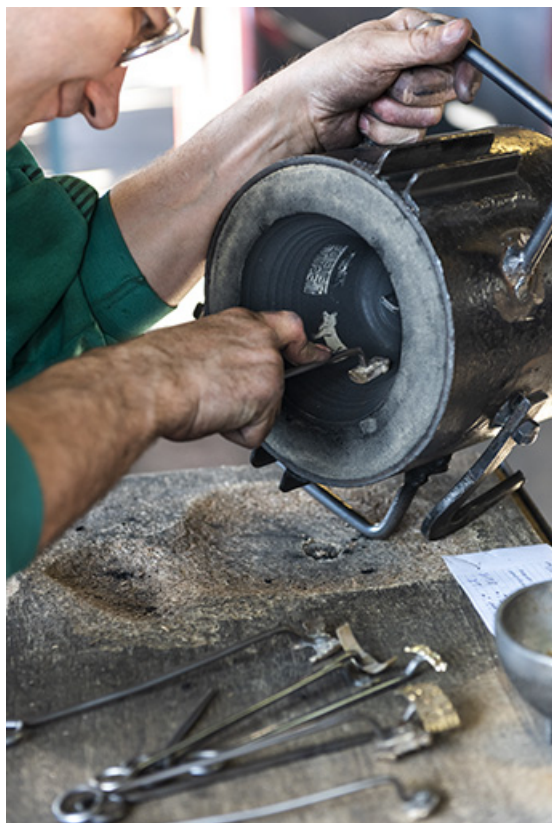
Fabrication du moule : impression de décors dans le moule en creux.
