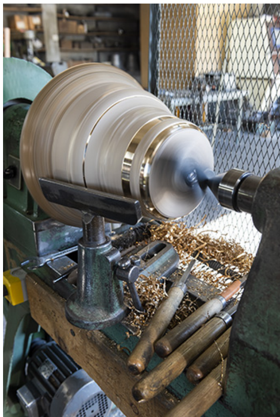
Tournage d'une cloche : la cloche en rotation.
