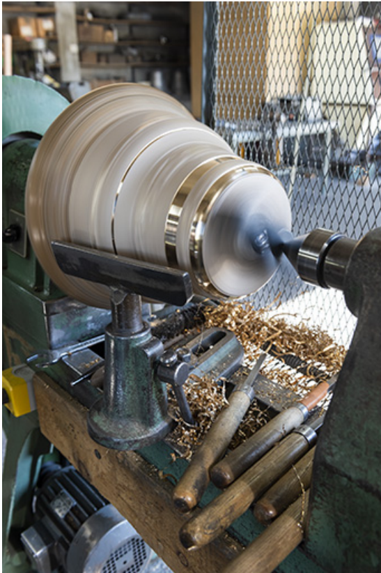
Tournage d'une cloche : la cloche en rotation.
