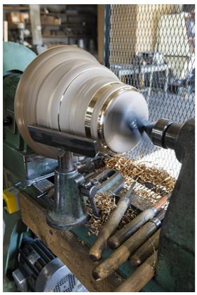
**Tournage d'une cloche : la cloche en rotation.** 25, Les Fins, 4 route de Morteau
