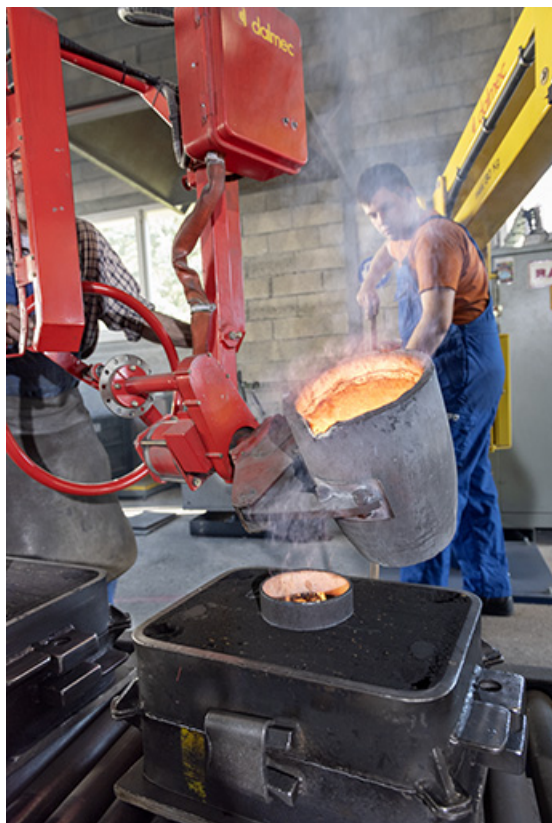
Coulée dans un grand châssis.
