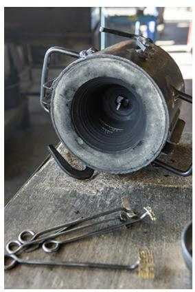
Fabrication du moule : moule en creux avec inscription et outils. 25, Les Fins, 4 route de Morteau
