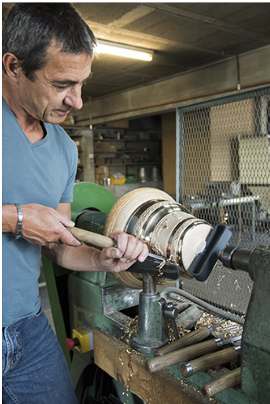
Tournage d'une cloche : geste de l'ouvrier.
