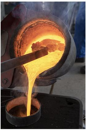
Coulée dans un grand châssis : les scories sont éloignées à l'aide d'une barre métallique. 25, Les Fins, 4 route de Morteau
