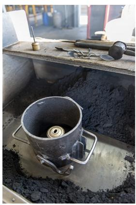
Fabrication du moule : le modèle dans son châssis. 25, Les Fins, 4 route de Morteau
