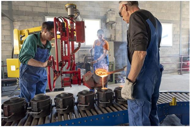
Coulée dans un petit châssis. 25, Les Fins, 4 route de Morteau
