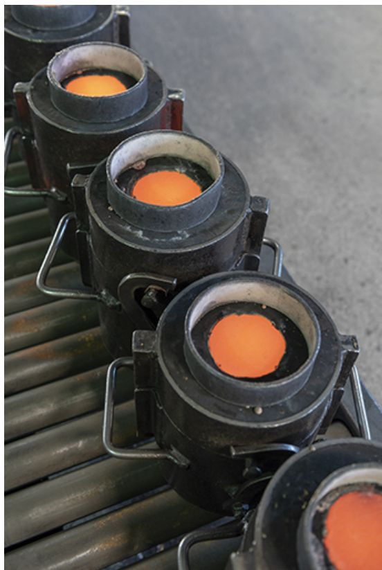
Refroidissement du bronze dans des petits châssis.
