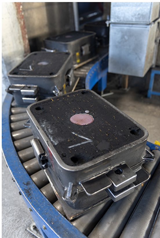
Refroidissement du bronze dans des grands châssis.
