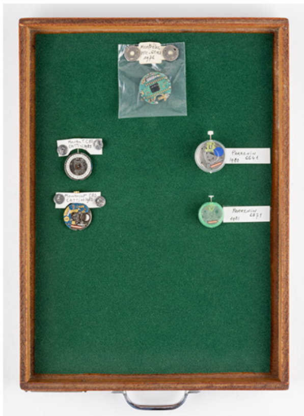
Modules à quartz étudiés par le Cetehor dont, en haut, un Montrelec MTC-61 NU (1976). (Collection Cetehor, Besançon). 25, Besançon, 39 avenue de l' Observatoire
