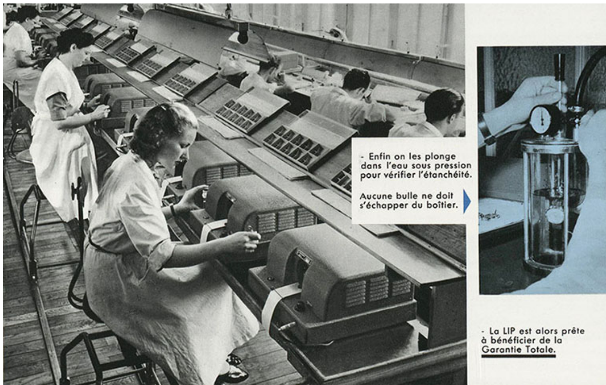
Contrôle d'étanchéité, fotogr., 1956. 25, Besançon, 4 à 7 rue des Chalets
