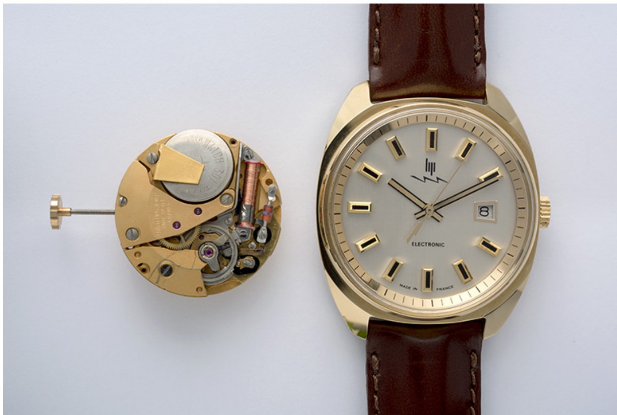
Montre-bracelet électromécanique dite Lip Electronic, à côté d'un mouvement Lip R 184 vu côté ponts. 25, Maîche
