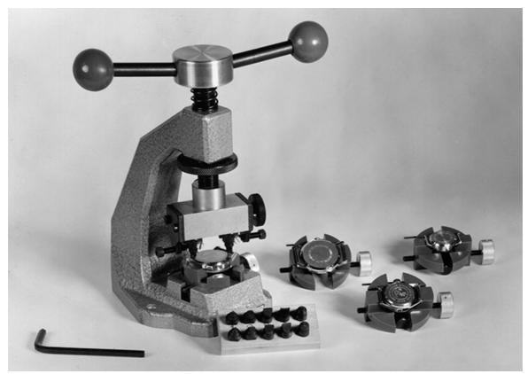
[Exemple d'appareil développé pour la société : potence à ouvrir et fermer les boîtes de montre, fabriquée au Japon dans les années 1970].
