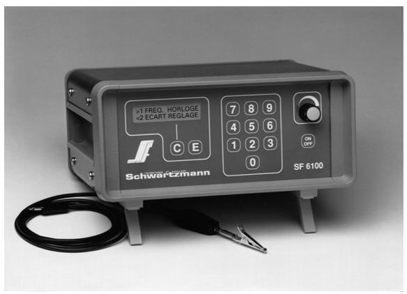
[Exemple d'appareil développé pour la société : chronocomparateur pour horloges et pendules SF 6100, inventé par Daniel Gasne et fabriqué à partir de 1990 par ELC Centrad, à Annecy, Haute-Savoie].
