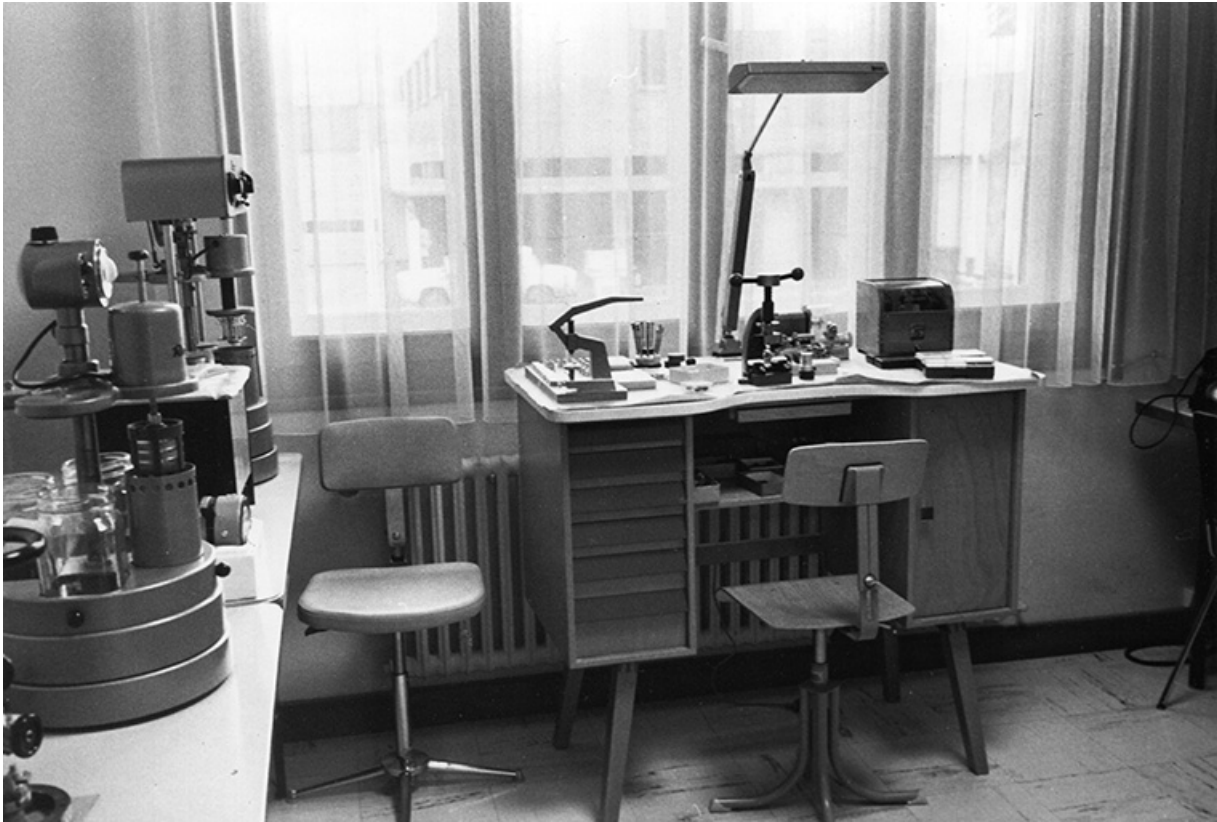
[Le local d'exposition], vers 1967 : établi avec diverses potences (à ouvrir et fermer les boîtes, à poser les verres et à chasser). 25, Morteau, 12 rue René Payot
