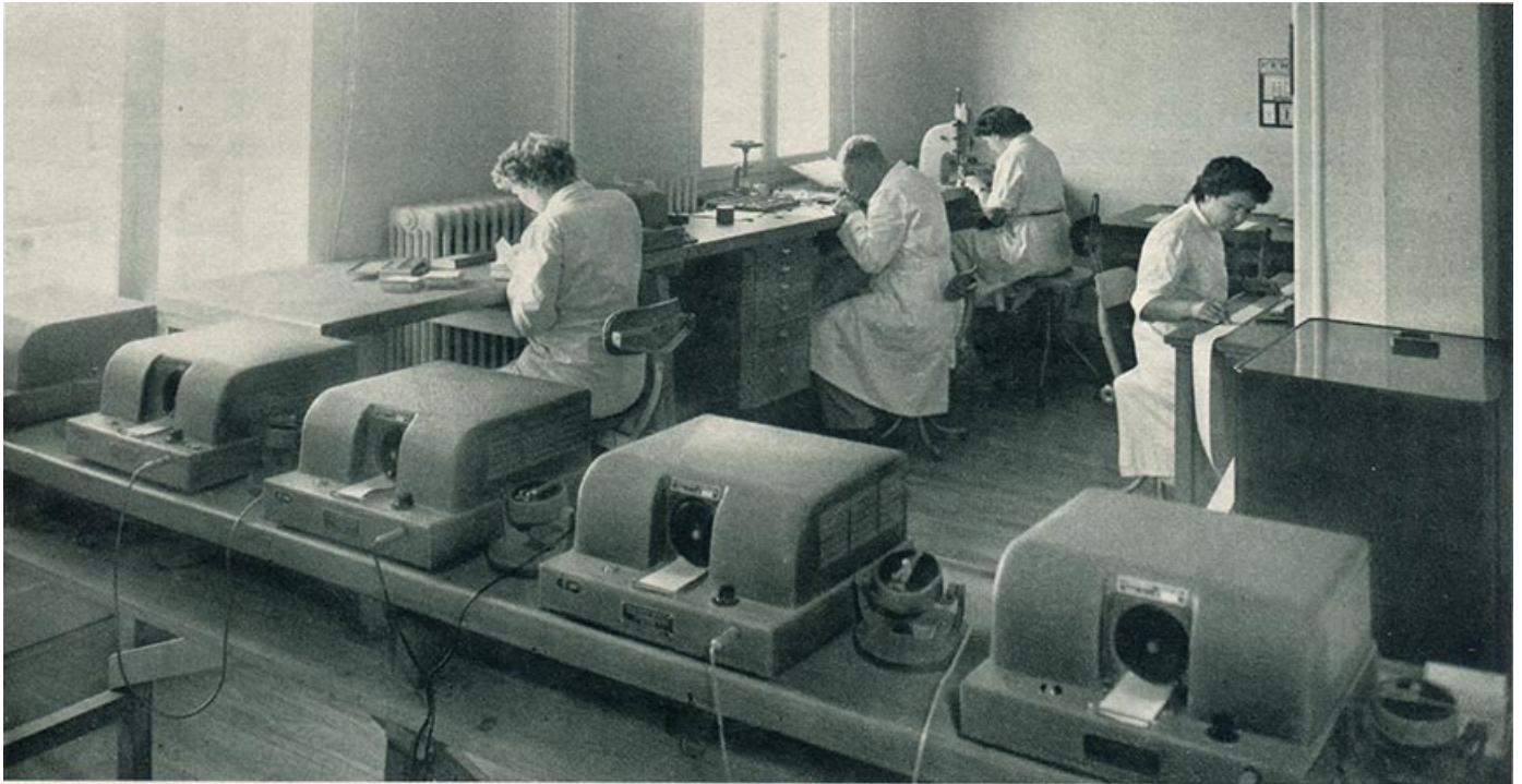
SERVICE OFFICIEL DE CONTRÔLE DES MONTRES, BATTERIE DE 15 VIBROGRAPHS LEPAUTE POUR LE CONTROLE DE LA MARCHE INSTANTANÉE DES MONTRES
