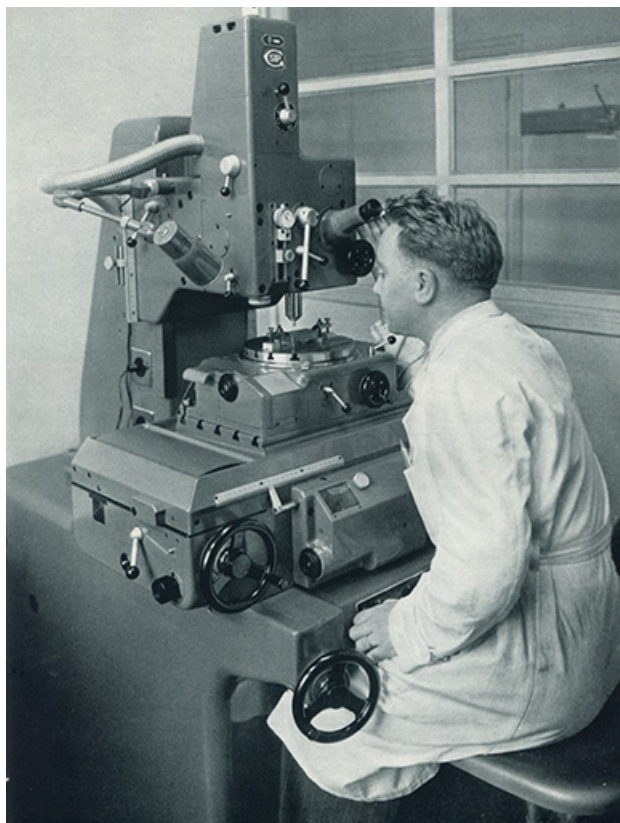
Atelier de mécanique. Machine à pointer (usinage des pièces), 1955. 25, Besançon, 16 avenue Carnot
