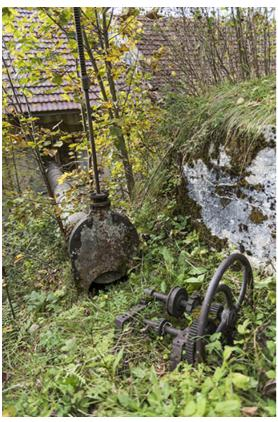
Eléments de vannage pour la prise d'eau de la turbine. 25, Montlebon
