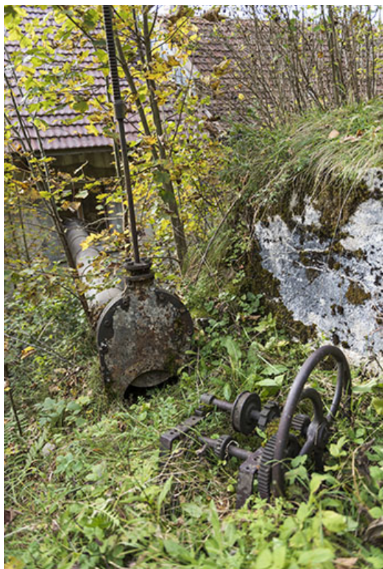
Éléments de vannage pour la prise d'eau de la turbine.
