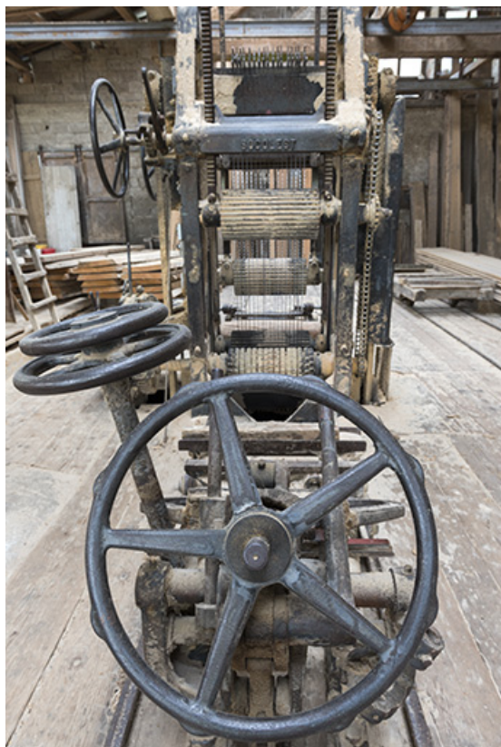
Atelier de fabrication : châssis de scie Socolest, volant sur le chariot d'entraînement. 25, Montlebon, 13 rue du Moulin, lieudit : Cornabey
