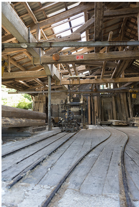
Atelier de fabrication : châssis de scie Socolest et rails.
