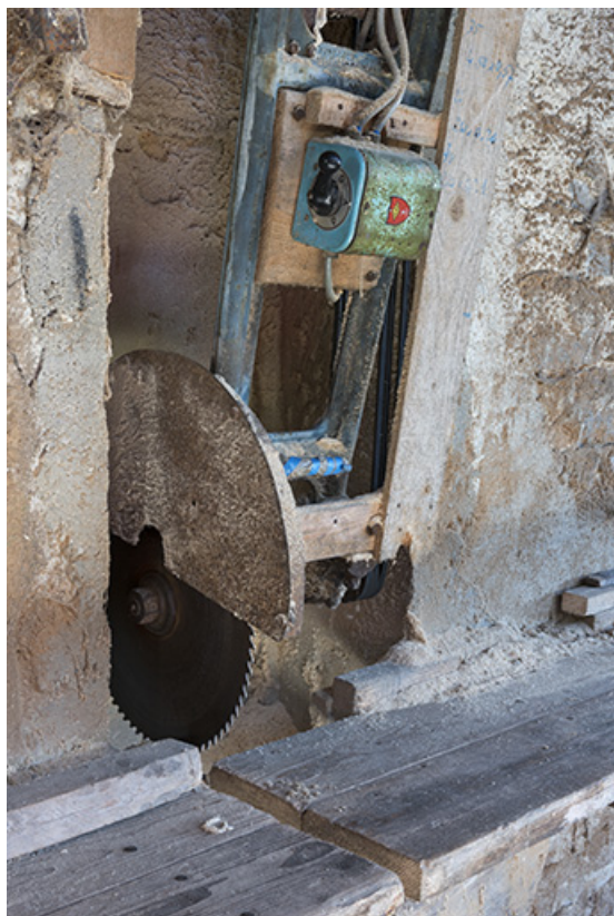
Atelier de fabrication : détail de la scie circulaire à balancier Guillet et Fils. 25, Montlebon, 13 rue du Moulin, lieudit : Cornabey
