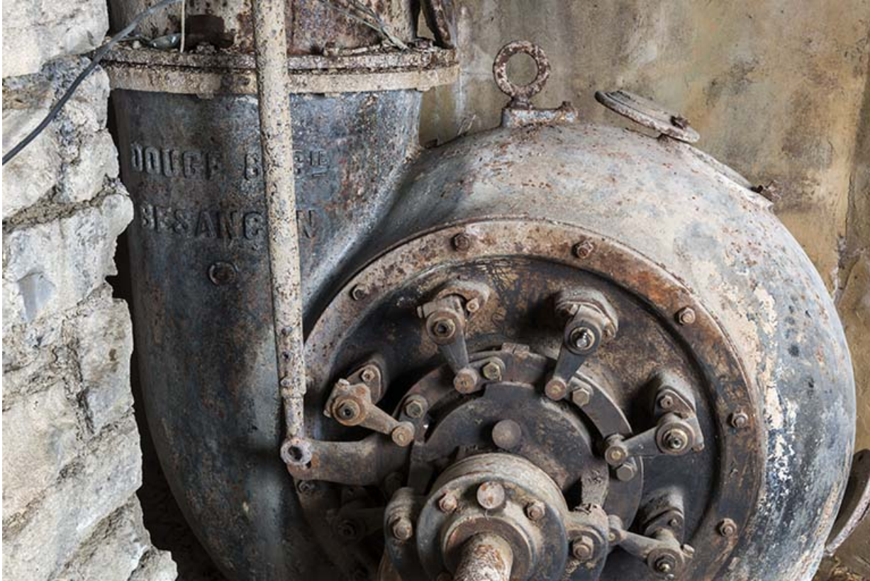
Atelier de fabrication, sciurier : turbine Douge. 25, Montlebon
