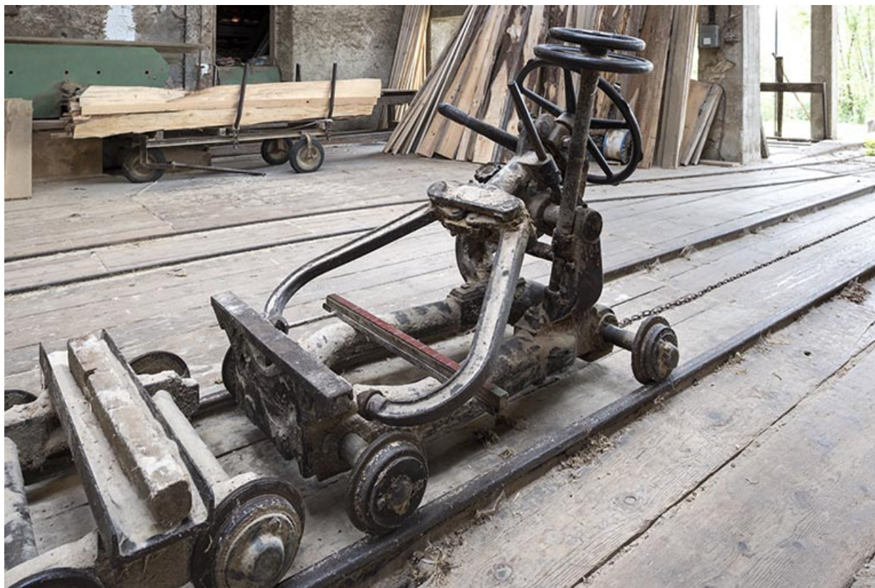
Atelier de fabrication : châssis de scie Socolest, chariot d'entraînement. 25, Montlebon, 13 rue du Moulin, lieudit : Cornabey
