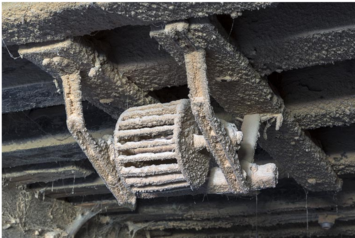
Atelier de fabrication, sciurier : lanterne utilisée par le système d'évacuation de la sciure.
