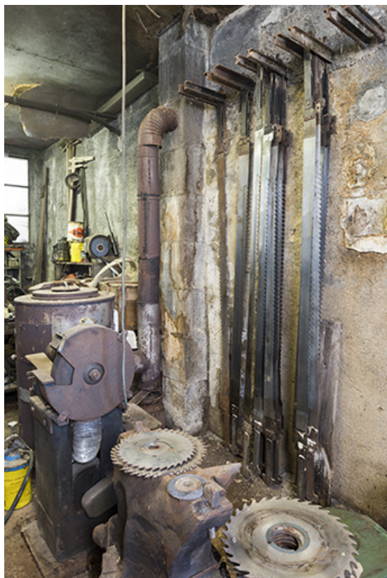
Atelier de réparation et d'affûtage : lames de scie circulaire et de châssis.
