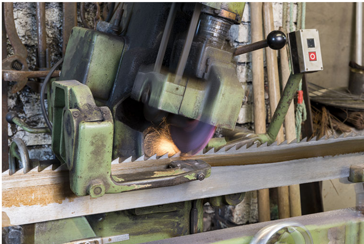
Atelier de réparation et d'affûtage : affûtage d'une lame de châssis de scie. 25, Montlebon, 13 rue du Moulin, lieudit : Cornabey
