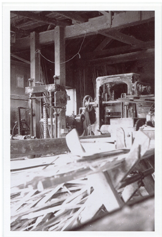
[Châssis de scie à coulisses en bois, à gauche, et petit châssis Socolest], années 1950. 25, Montlebon, 13 rue du Moulin, lieudit : Cornabey
