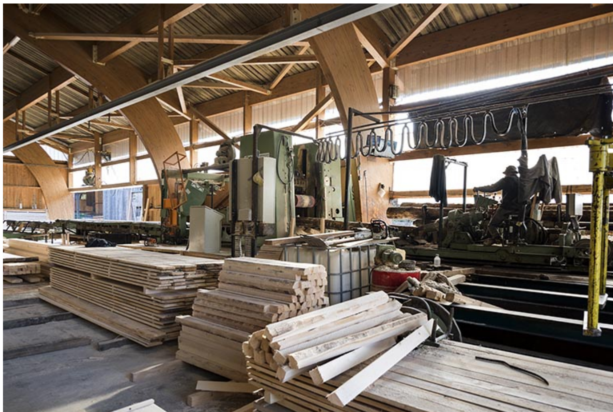
Atelier de fabrication (2000) : châssis multiple Möhringer.
