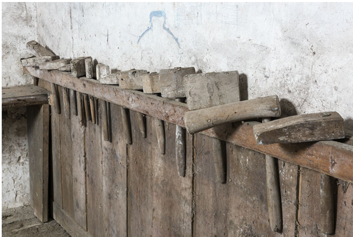
Atelier de fabrication : maillets de dinandier sur leur support.
