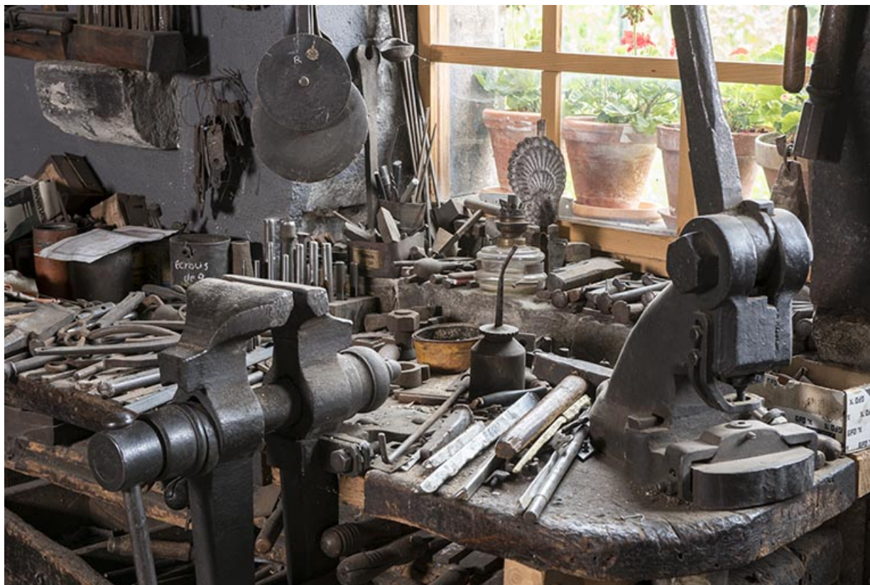
Forge : établi avec étau et machine à poinçonner ou river.
