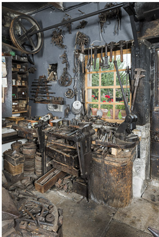
Forge : établi derrière la fenêtre, étaux et transmission.
