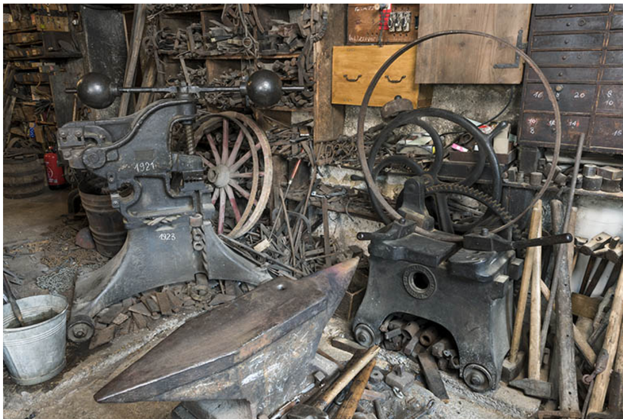
Forge : enclume, cisaille à balancier A. Vernet (Dijon) et refouleuse Jules Groperrin (Besançon). 25, Grand'Combe-Châteleu, lieudit : les Cordiers
