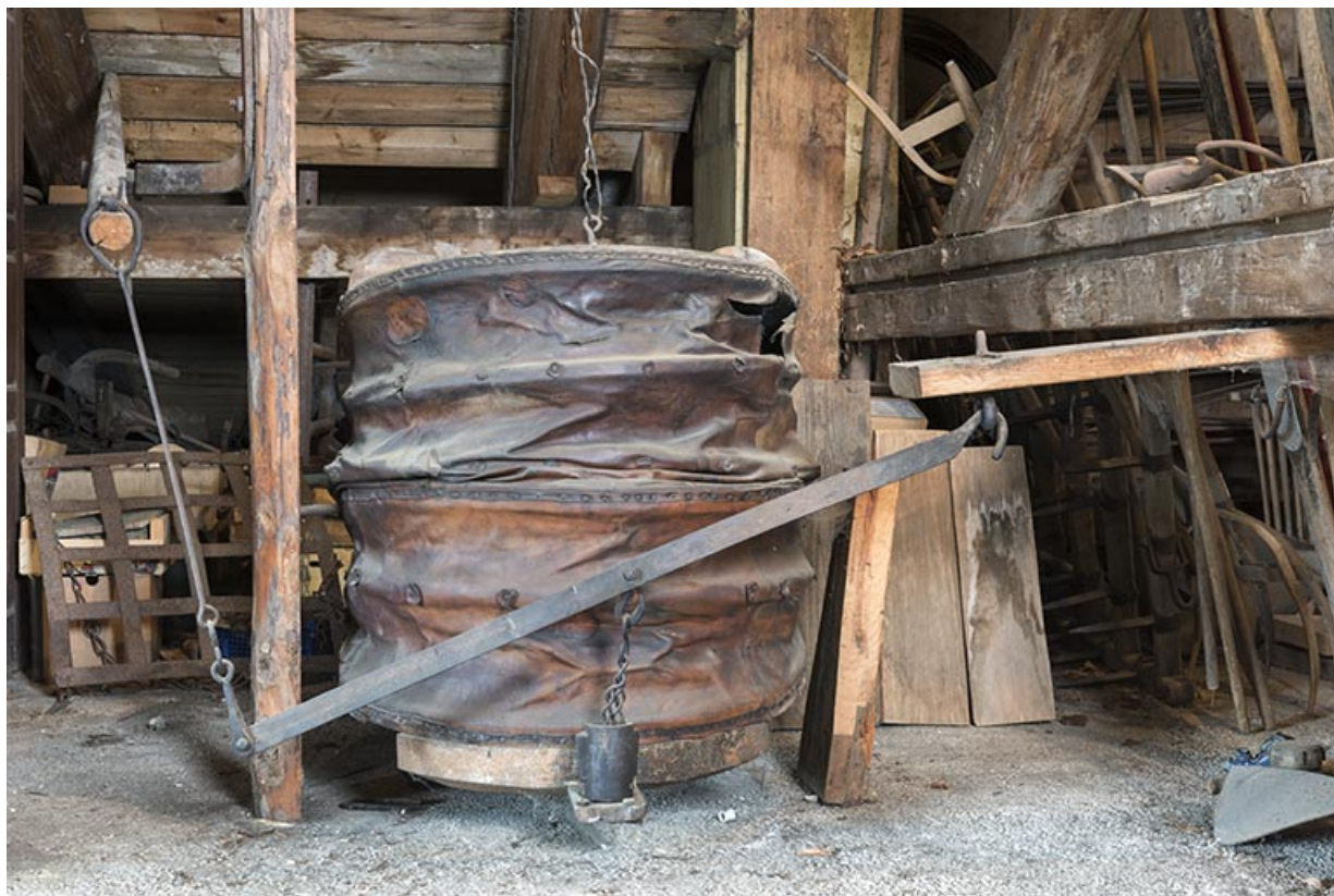
Soufflet en cuir : poids permettant la descente du fond.
