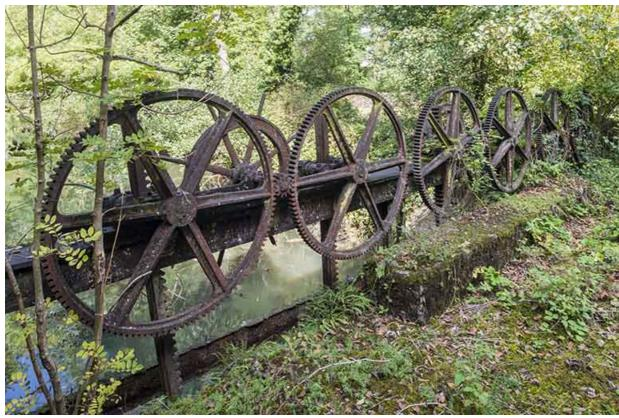
Mécanisme de levage du vannage.
