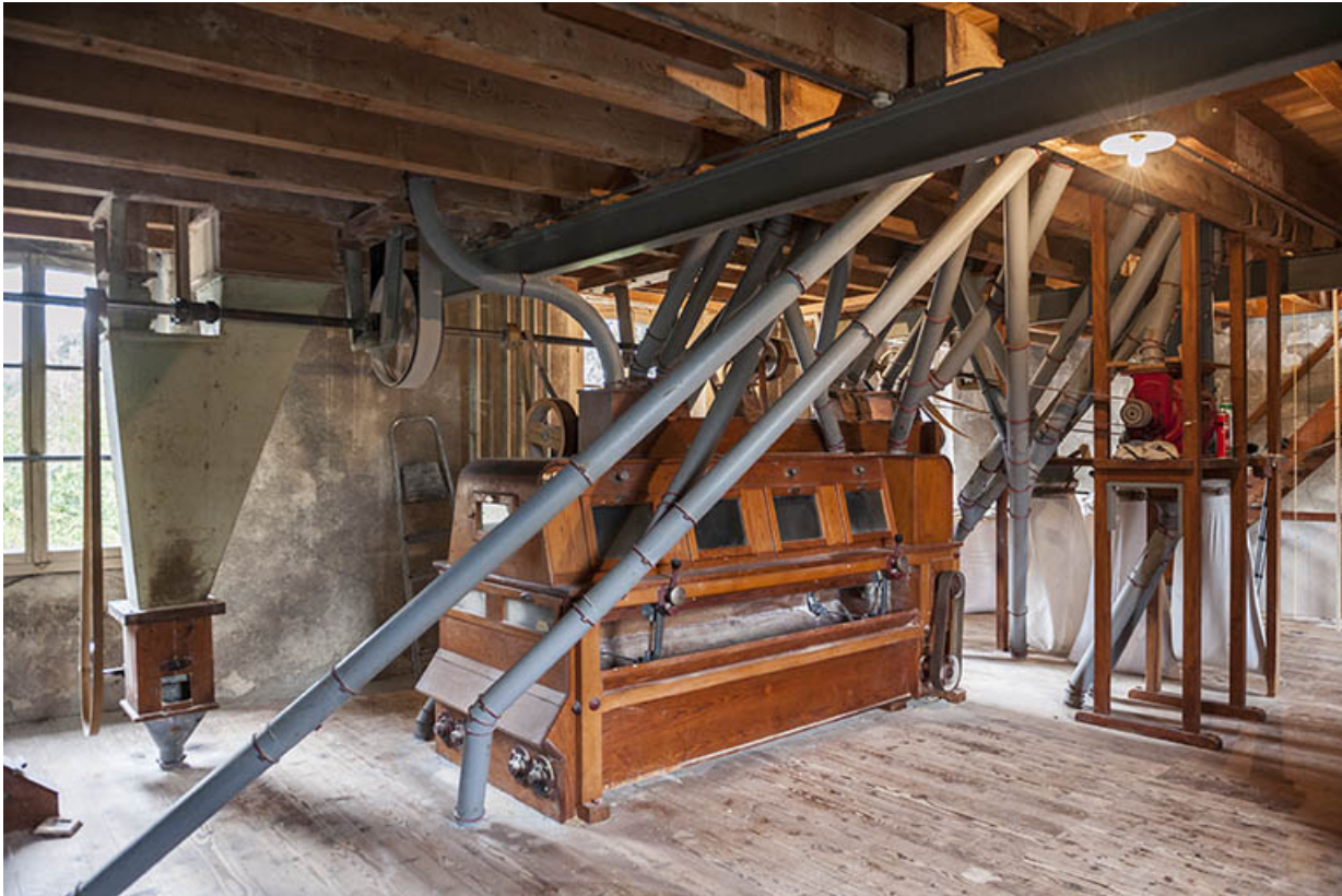
Deuxième étage. Sasseur Nehlig, Heuser et Cie.
