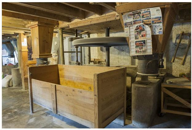
Rez-de-chaussée. Transmission par engrenages de la turbine.
