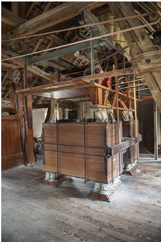
Troisième étage. Planschifter double Nehlig, Heuser et Cie. 25, Liesle, lieudit : le Moulinot
