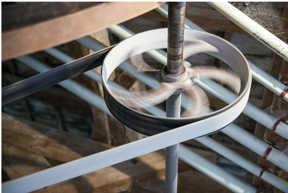
Troisième étage. Poulie et courroie du plansichter.
