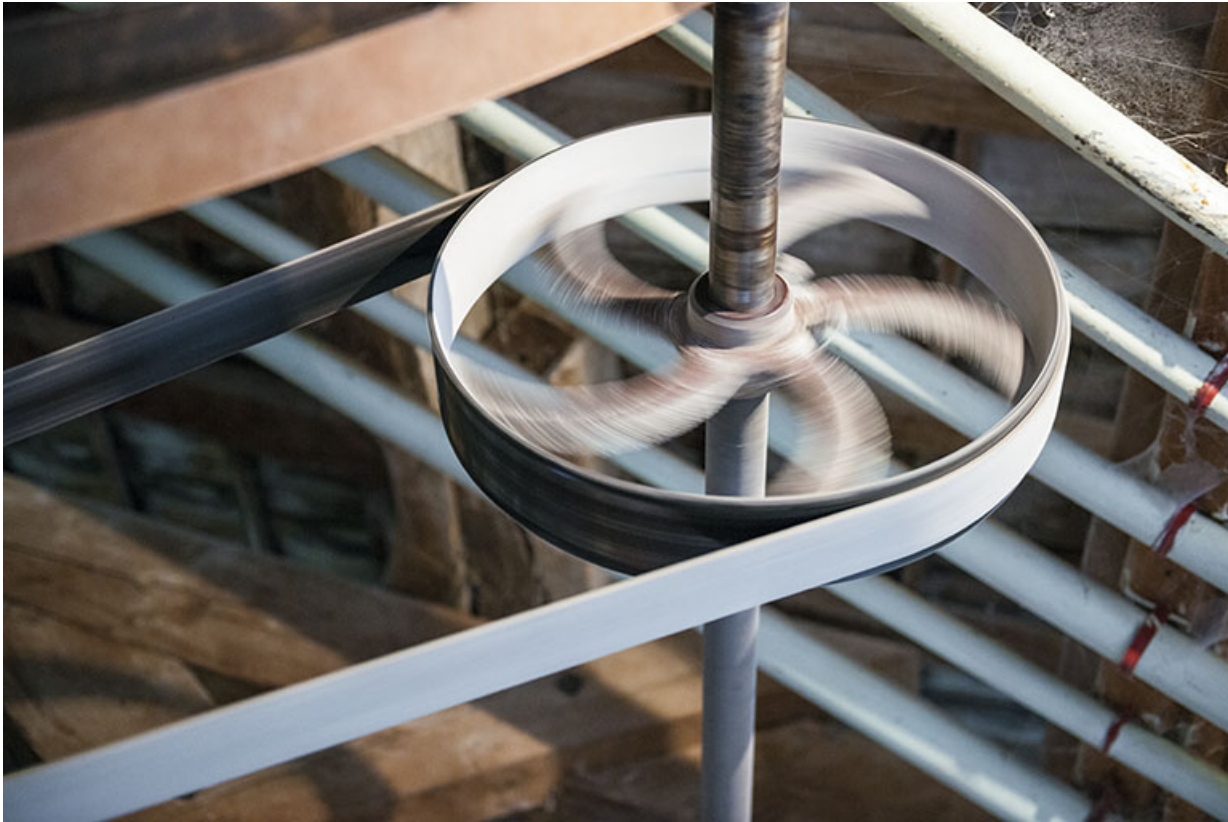
Troisième étage. Poulie et courroie du plansichter.
