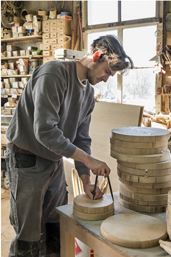
Tournerie de tabourets et ébénisterie : traçage d'une pièce de tabouret. 25, Grand'Combe-Château, 5-9 Pré Rondot
