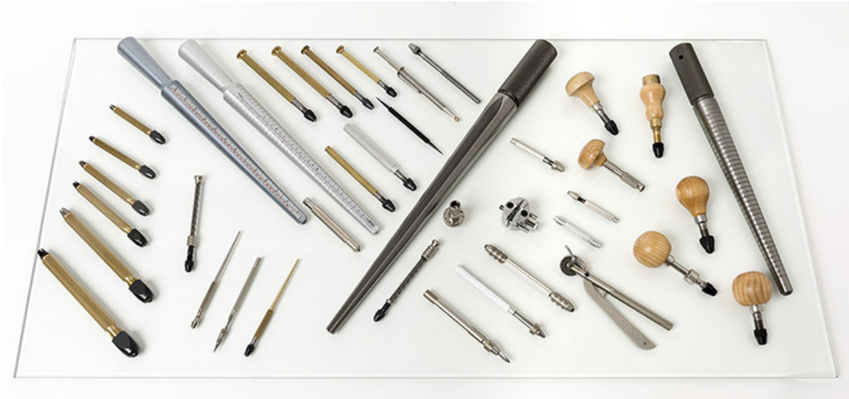
Production de la société Grandidier : pinces à morille, mandrins, triboulets, outils de graveur, pince à scier les bagues, etc. 25, Grand'Combe-Châteleu, 14 rue les Grands Saules, lieudit : les Forges
