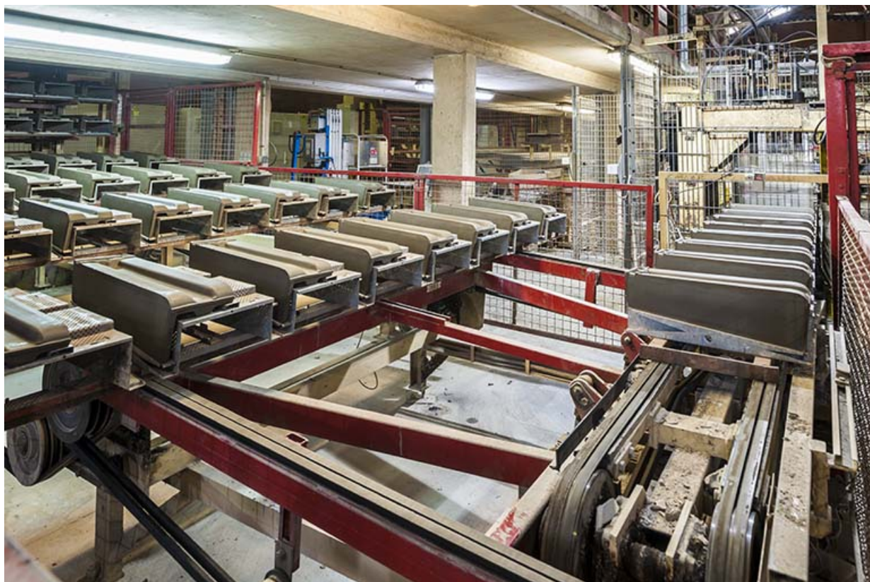
Tuiles en sortie de la mouleuse.
