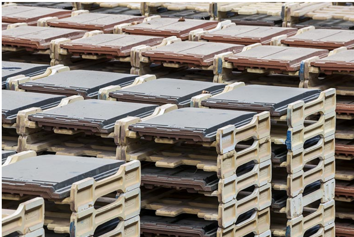
Unité de fabrication dite UL 2 (à l'arrêt). Détail d'un chariot de tuiles, avec supports réfractaires individuels (pour four piscine).
