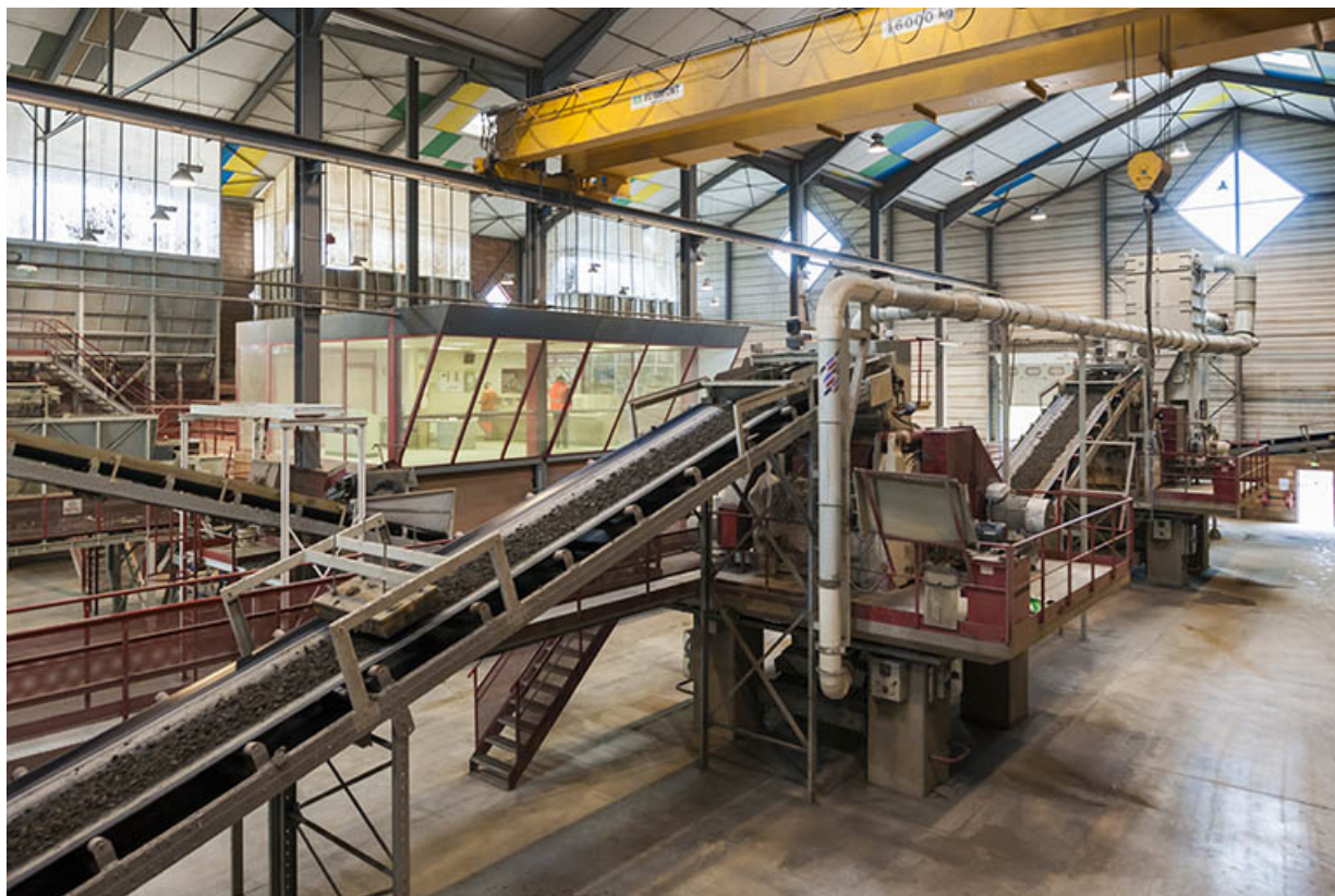
Unité de préparation des terres. De gauche à droite : poste de contrôle, laminoir-dégrossisseur et laminoir-finisseur. 25, Lantenne-Vertière route de Mercey
