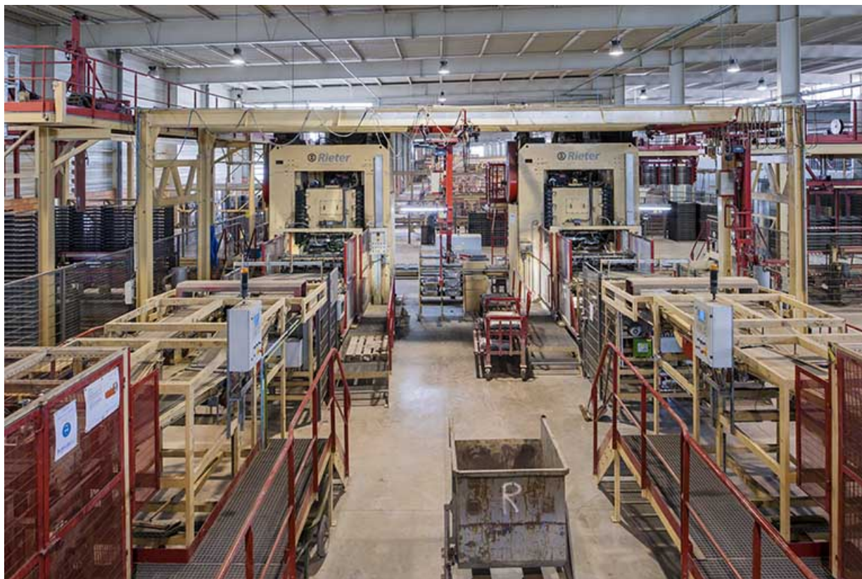
Unité de fabrication dite UL 5. Les deux lignes de moulage-pressage. 25, Lantenne-Vertière route de Mercey
