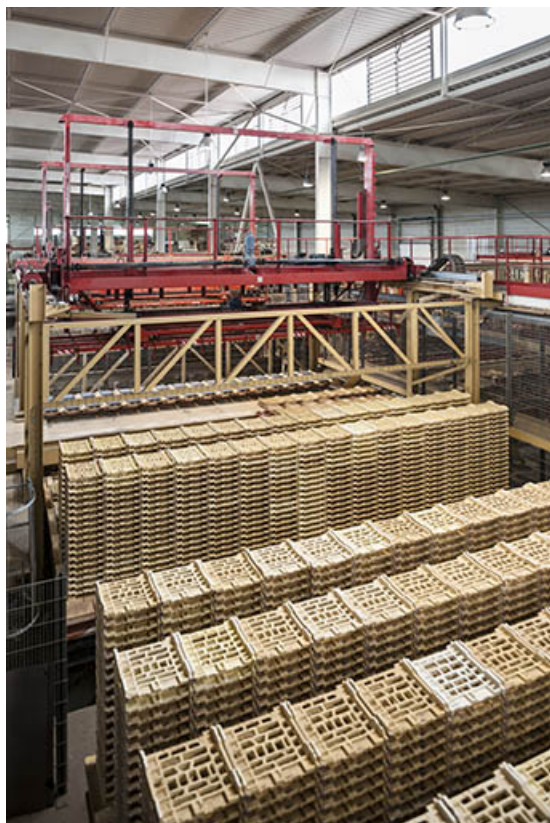
Unité de fabrication dite UL 5. Supports réfractaires pour la cuisson des tuiles. 25, Lantenne-Vertière route de Mercey
