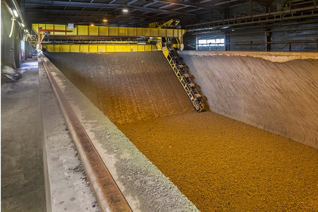
Fosse à terre. Excavatrice (reprise de la terre après maturation).
