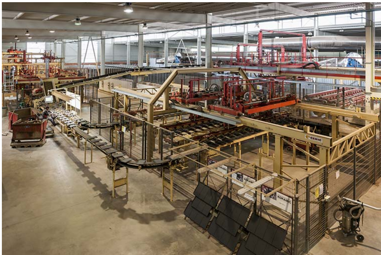
Unité de fabrication dite UL 5. Acheminement des tuiles cuites vers le contrôle. 25, Lantenne-Vertière route de Mercey
