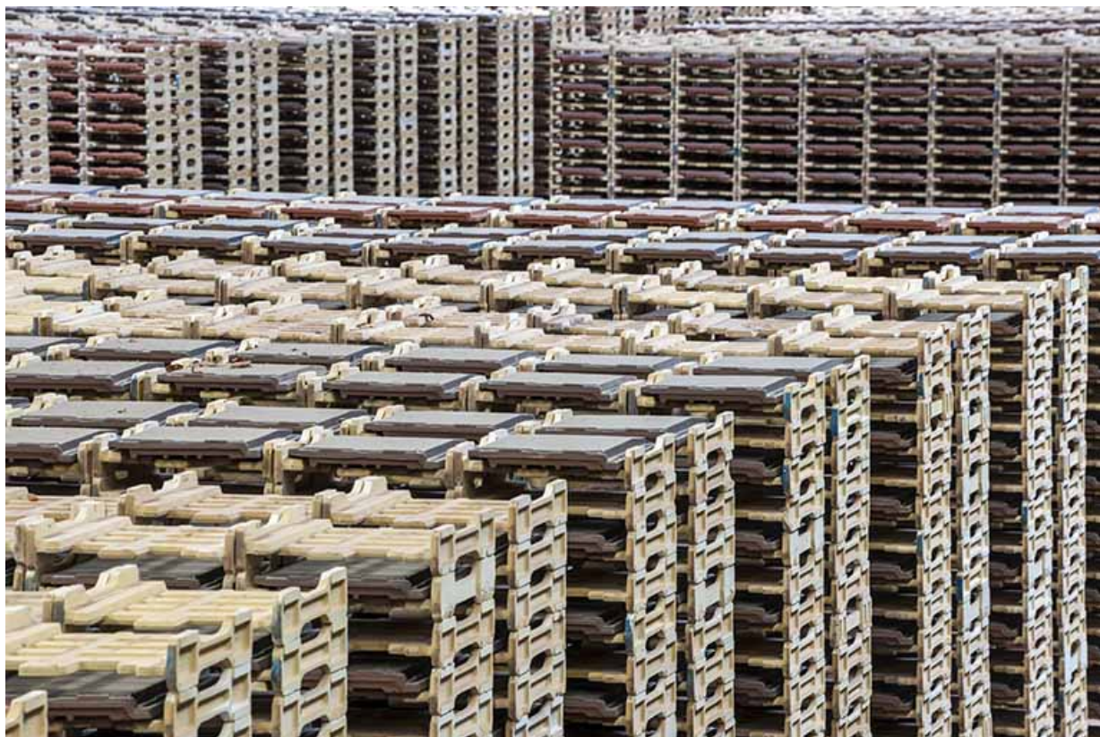
Unité de fabrication dite UL 2 (à l'arrêt). Empilement de tuiles sur chariots réfractaires (pour four piscine). 25, Lantenne-Vertière route de Mercey
