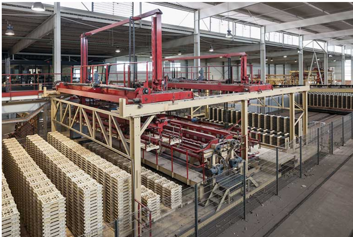
Unité de fabrication dite UL 5. Poste d'empilage-dépileage des tuiles sur supports réfractaires. 25, Lantenne-Vertière route de Mercey
