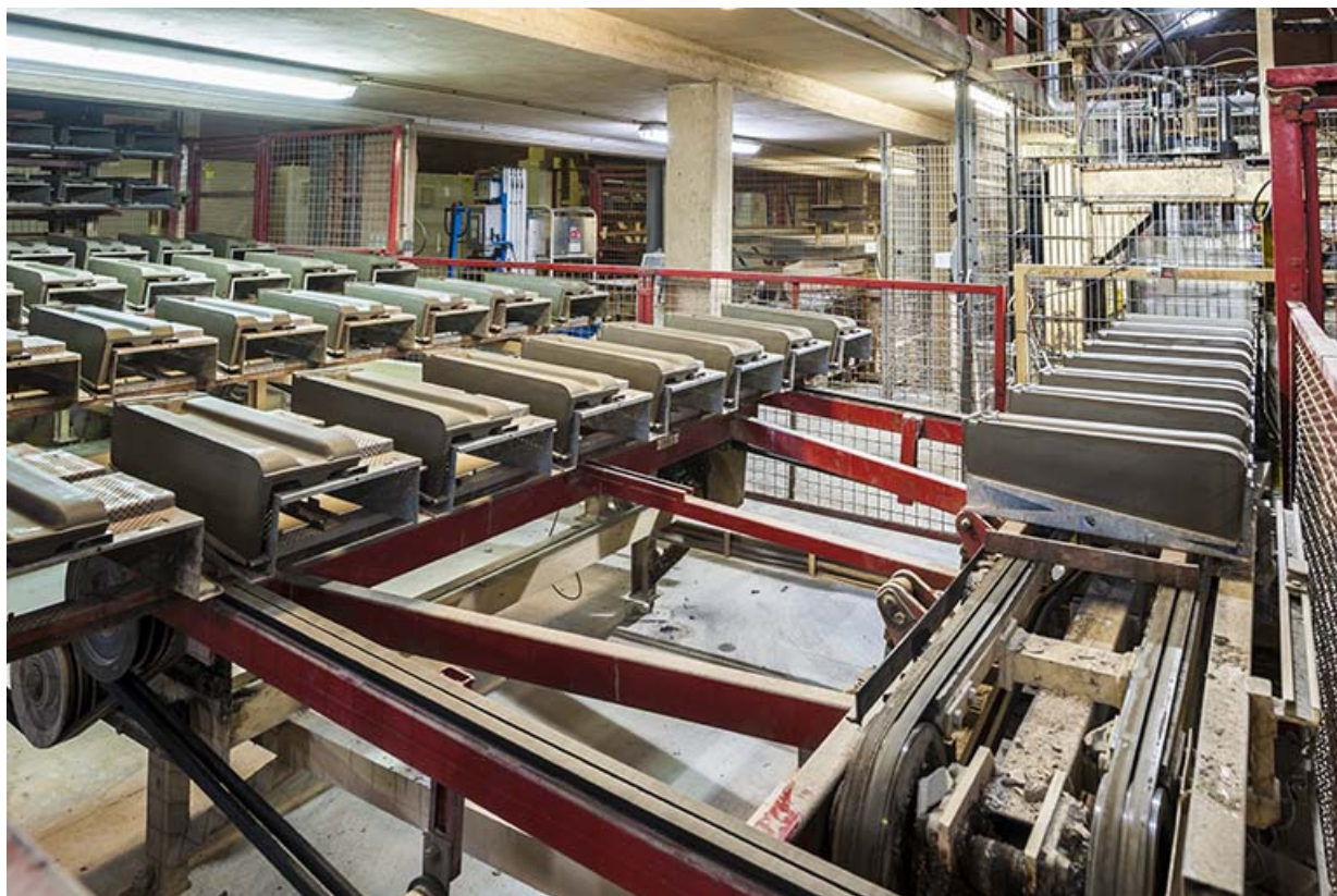
Tuiles en sortie de la mouleuse.
