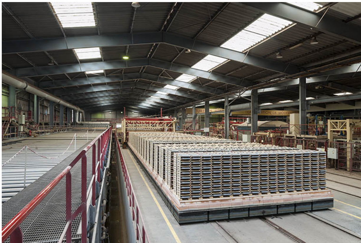
Unité de fabrication dite UL 2 (à l'arrêt). Four piscine (à gauche) et chariot réfractaire (à droite). 25, Lantenne-Vertière route de Mercey
