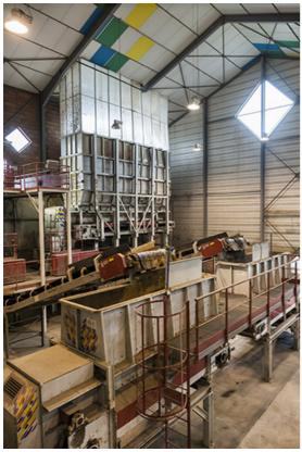
Partie sud de l'unité de préparation des terres. Au premier plan, doseurs-tampon. Au second plan, cellules des doseurs (pesée et brise-mottes).
