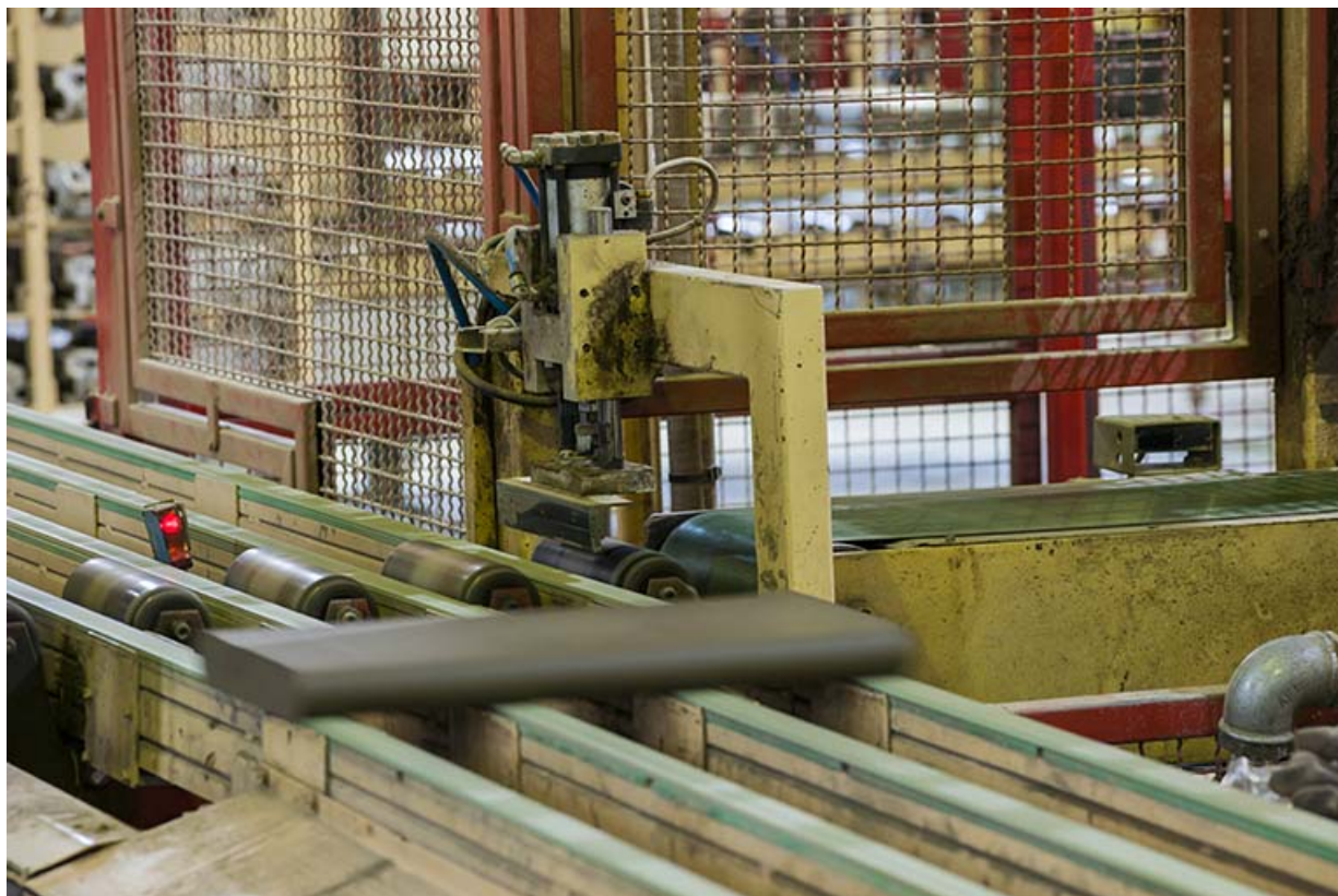
Unité de fabrication dite UL 3. Une "galette" après découpage par fil de la bande de terre. 25, Lantenne-Vertière route de Mercey
