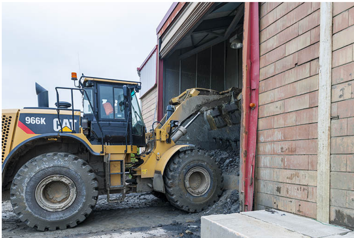
Chargement de la marne noire dans l'un des trois doseurs.
