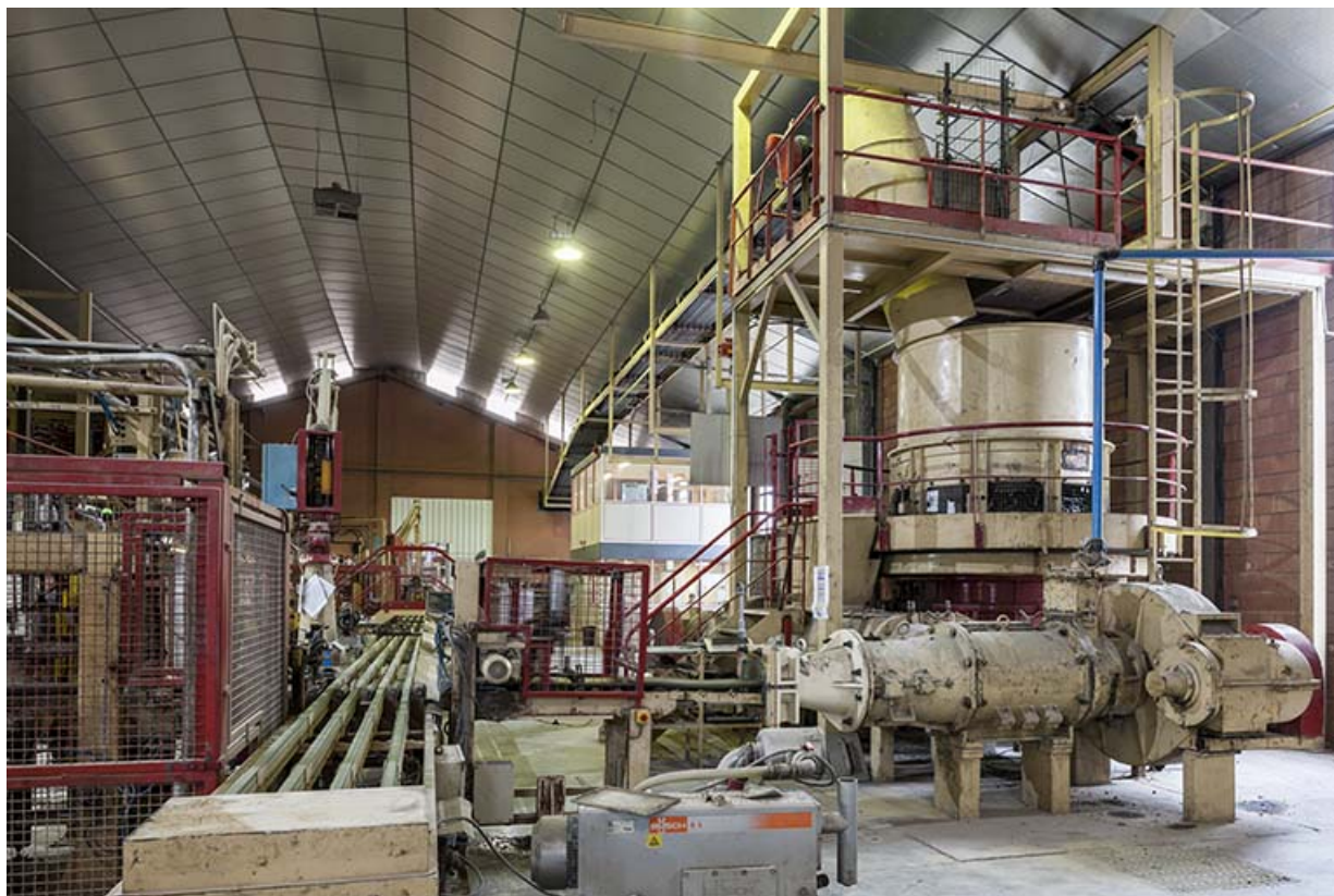
Unité de fabrication dite UL 3. Vue sur le malaxeur-râpeur et la mouleuse sous vide d'air. 25, Lantenne-Vertière route de Mercey
