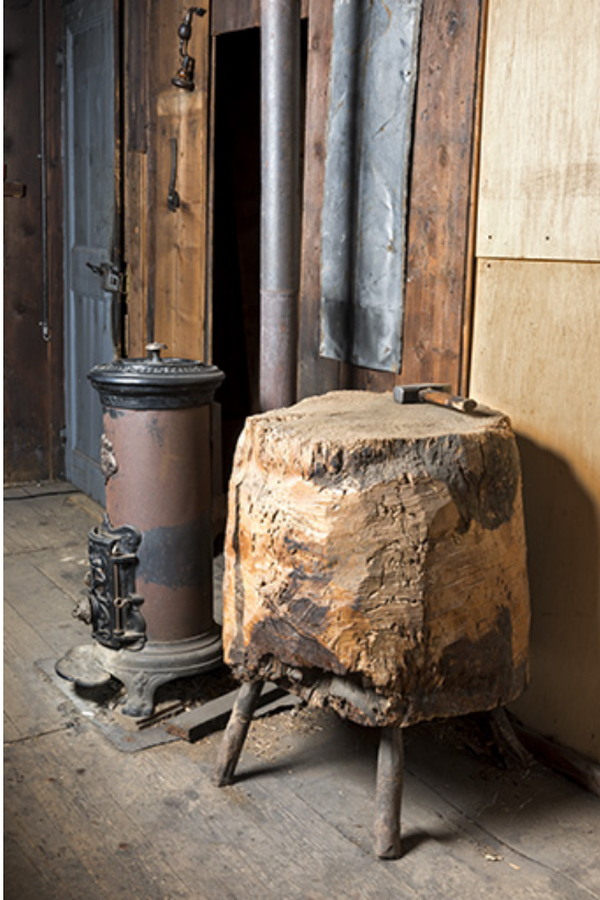
L'atelier : poêle et "tas" en bois pour redresser les calibres.
