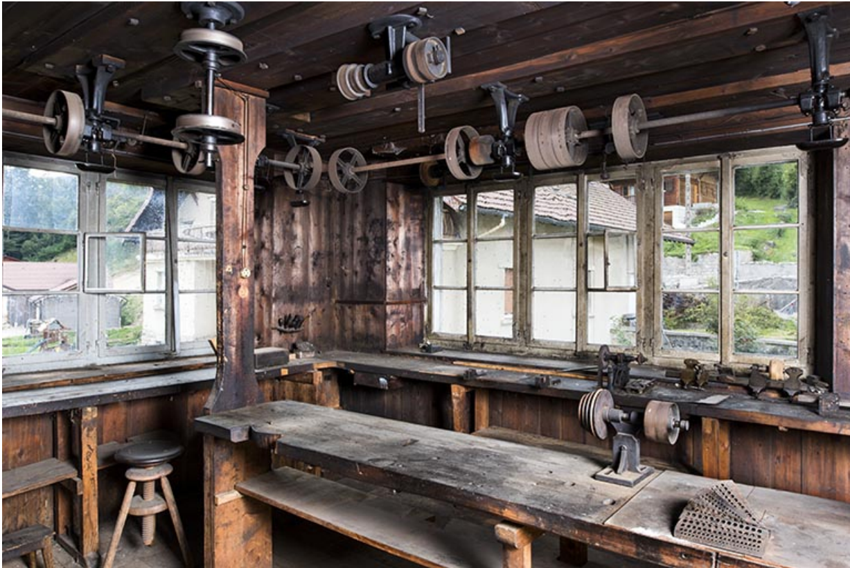
L'atelier, avec ses établis et ses transmissions.
