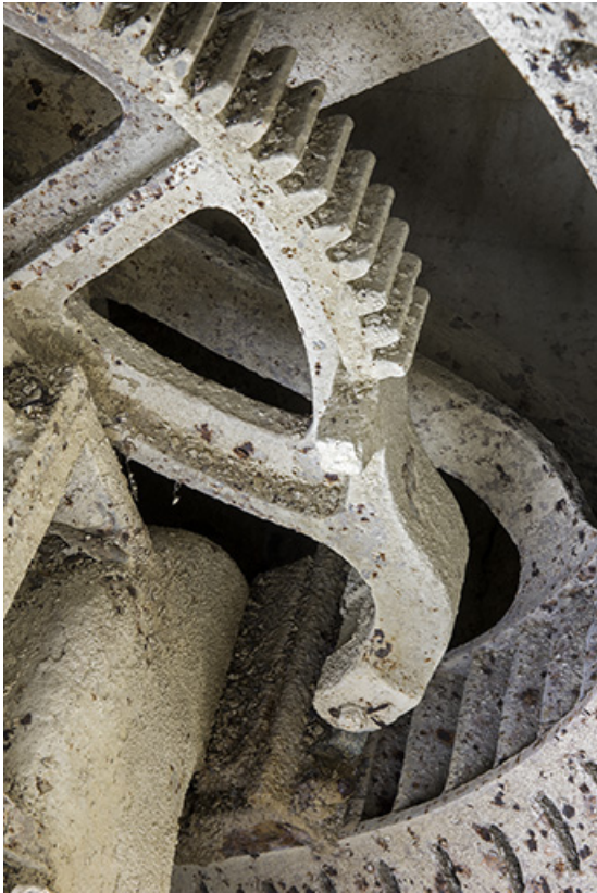
Usine : secteur commandant l'admission d'eau dans la turbine.
