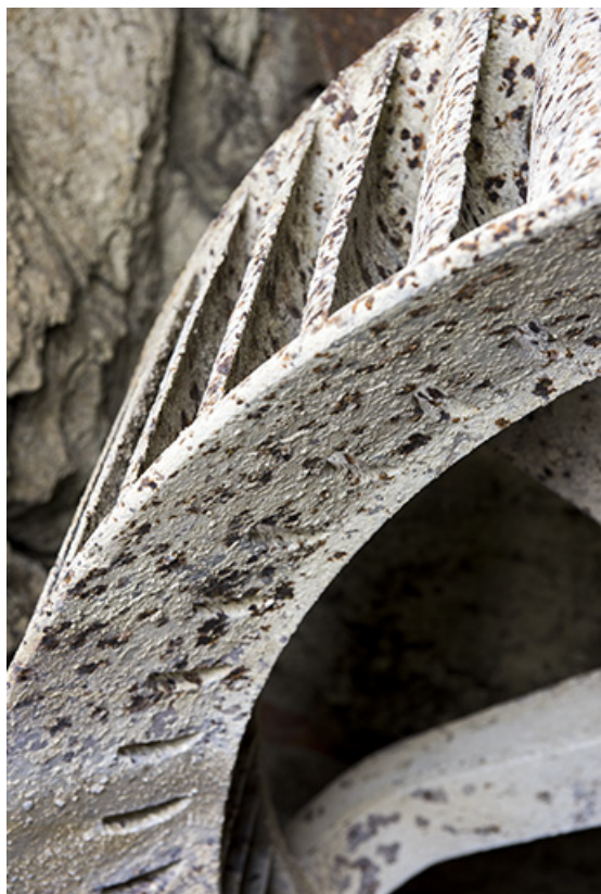
Usine : aubes de la turbine.
