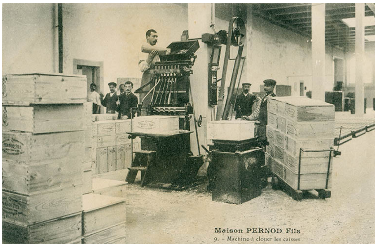
Maison Pernod Fils. Machine à clouer les caisses, carte postale, s.d. [fin 19e ou début 20e siècle]. 25, Pontarlier, 2 avenue de l'Armée de l'Est
