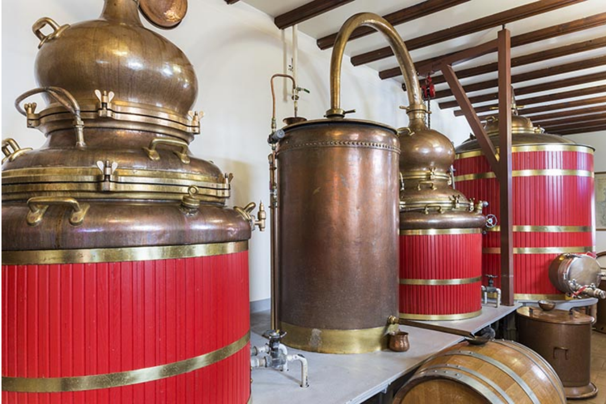
Alambics. Vue rapprochée des cucurbites et réfrigérants.
