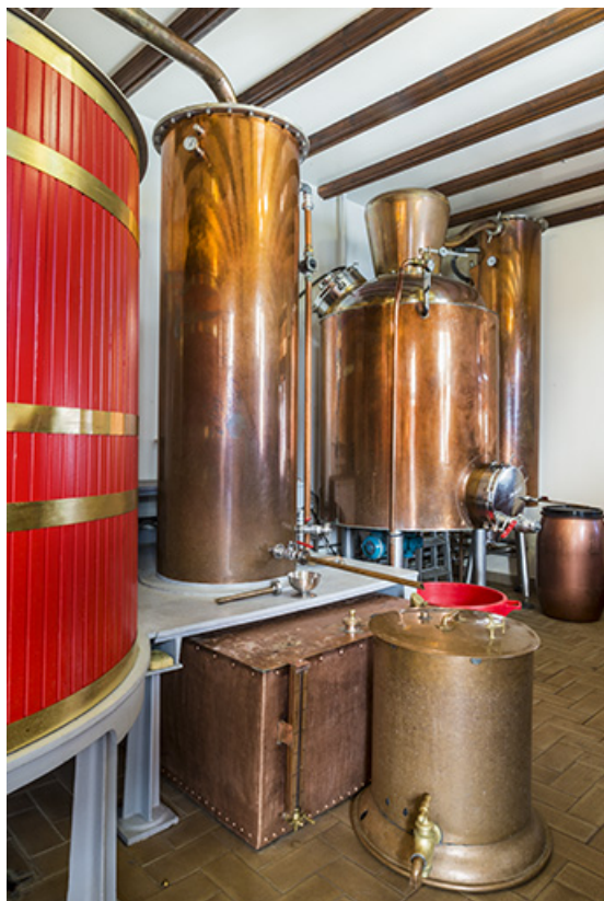
Alambic de 800 litres, de marque Rump (Strasbourg). 25, Pontarlier, 49 rue des Lavaux
