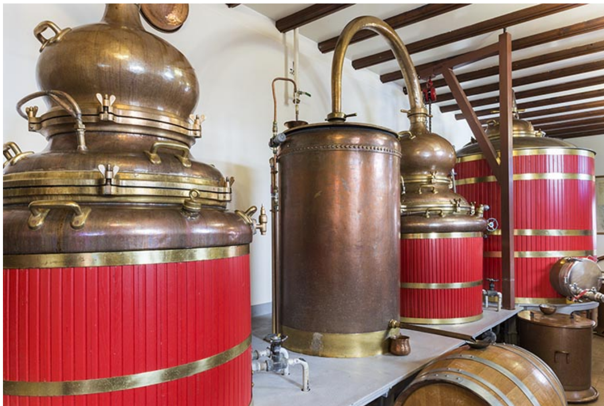
Alambics. Vue rapprochée des cucurbites et réfrigérants.
