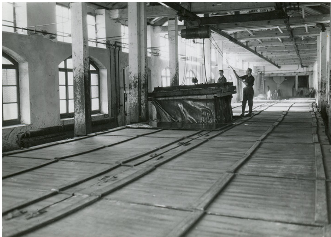
Salle des bains (bac de trempé des peaux), fotogr., s.d. [vers 1950]. 25, Pontarlier rue de la Fontaine
