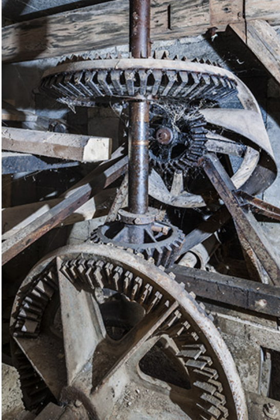
Rez-de-chaussée. Mécanisme de transmission par roues engrenées.
