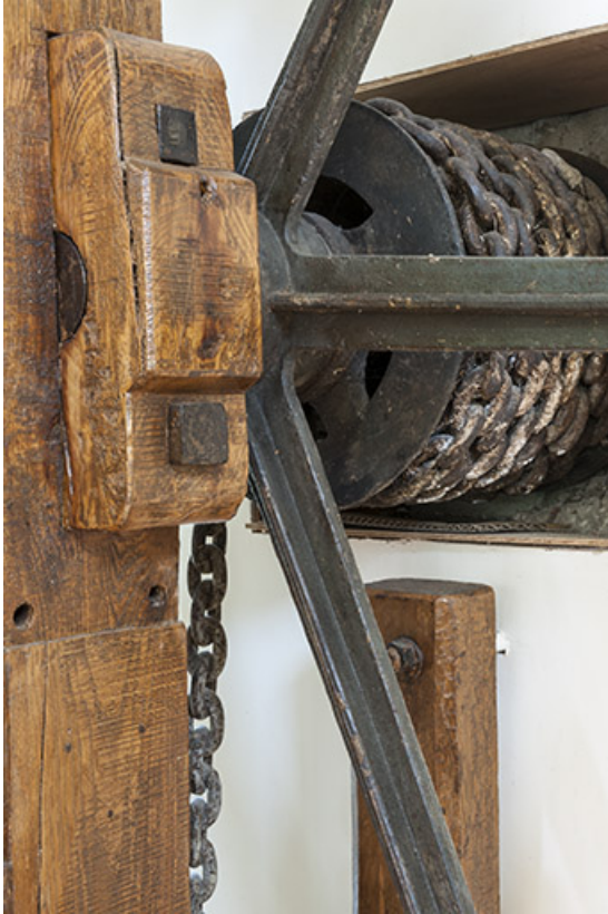
Mécanisme de levage. Détail du tambour d'enroulement de la chaîne.
