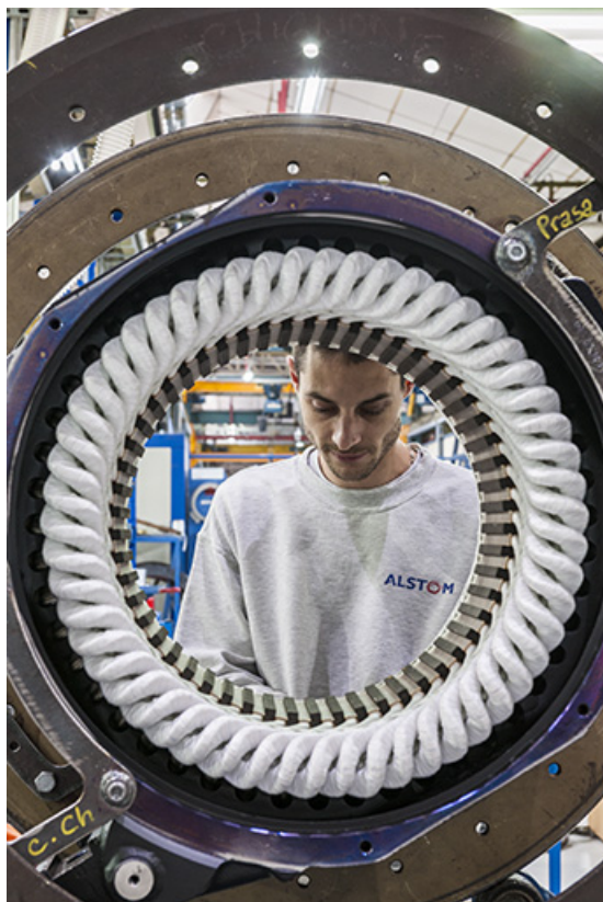
Atelier de bobinage. Montage des barres de cuivre sur un stator.
