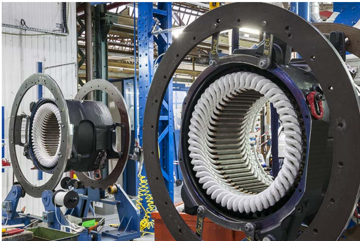
Atelier de bobinage. Stators équipés de barres de cuivre. 25, Ornans, 7 avenue du maréchal de Lattre de Tassigny
