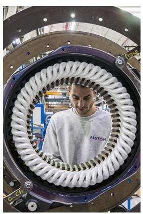
Atelier de bobinage. Montage des barres de cuivre sur un stator. 25, Ornans, 7 avenue du maréchal de Lattre de Tassigny
