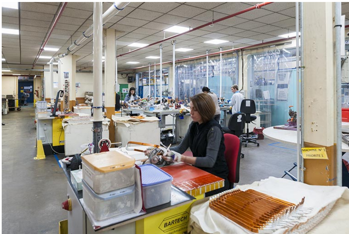
Isolation semi-automatique des barres de cuivre.
