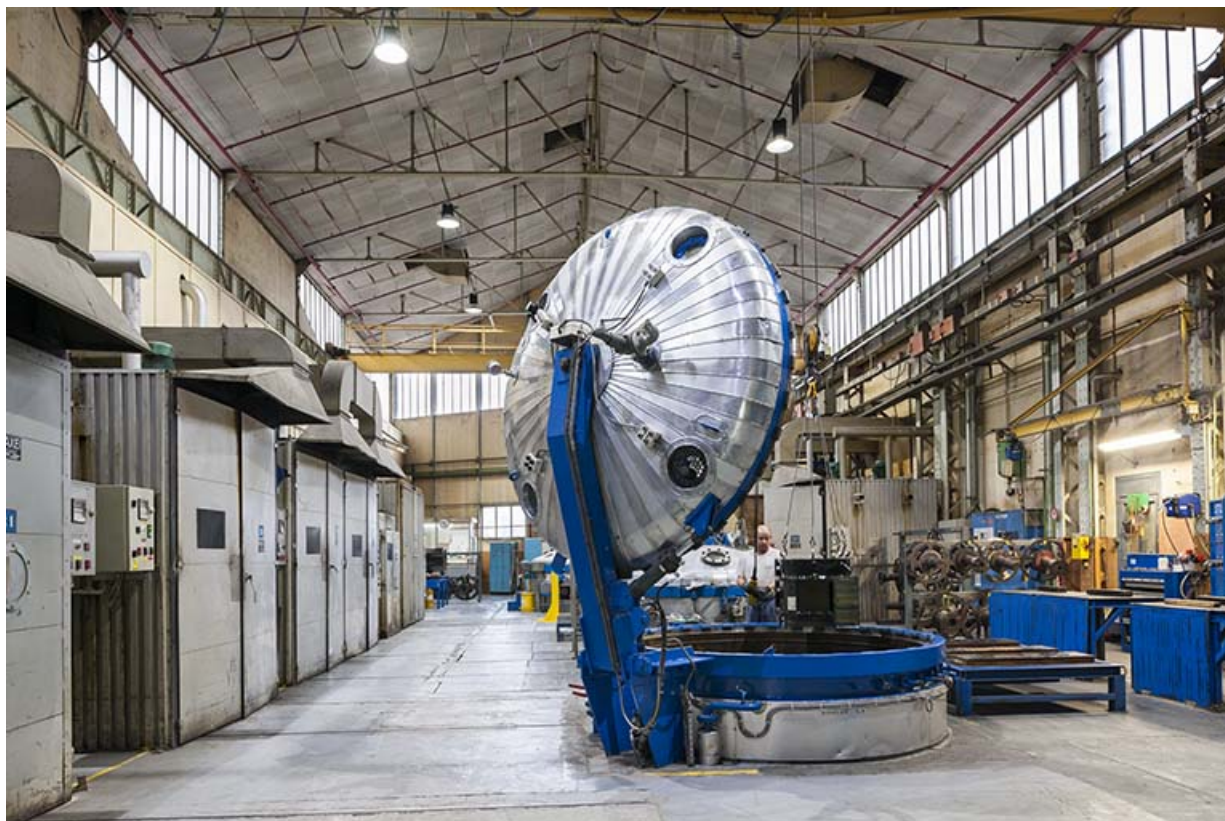
Atelier d'impregnation (autoclave ouvert).
