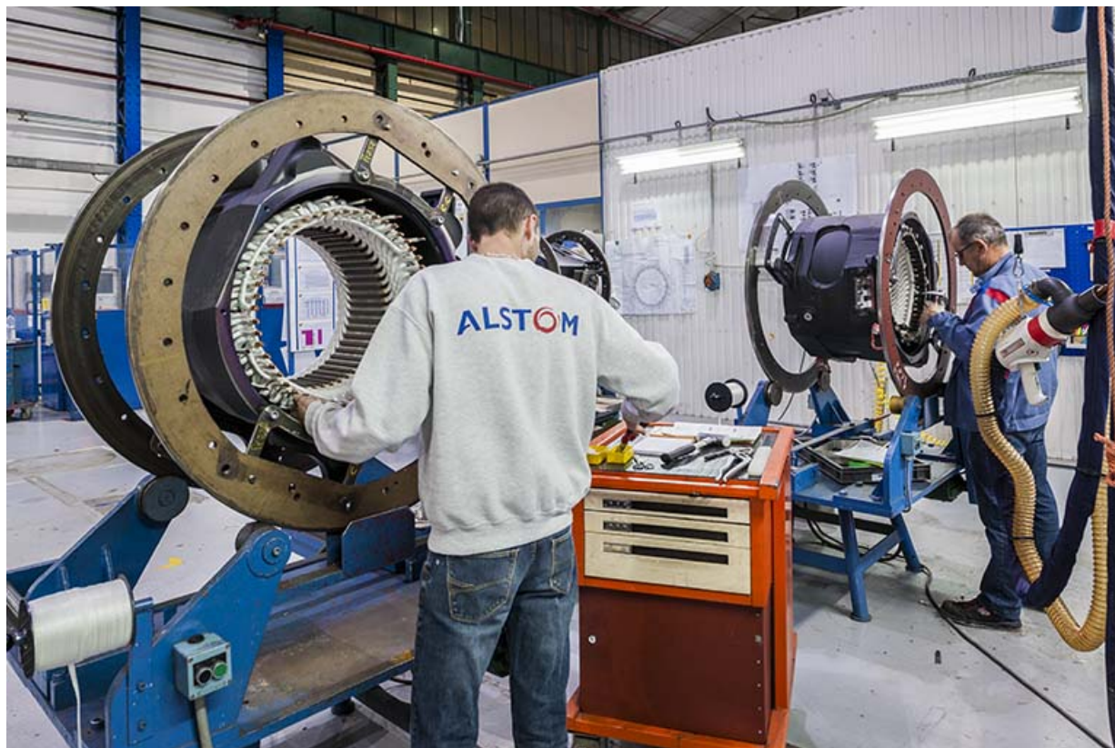
Atelier de bobinage. Montage des barres de cuivre sur les stators.
