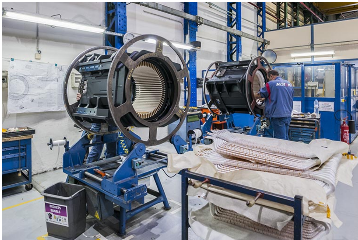
Atelier de bobinage. Montage des barres de cuivre. 25, Ornans, 7 avenue du maréchal de Lattre de Tassigny
