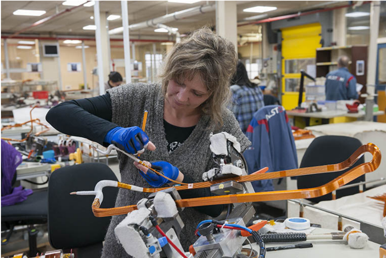
Isolation manuelle des barres de cuivre.
