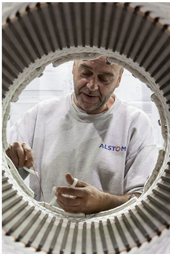
Atelier de bobinage. Montage des barres de cuivre. 25, Ornans, 7 avenue du maréchal de Lattre de Tassigny
