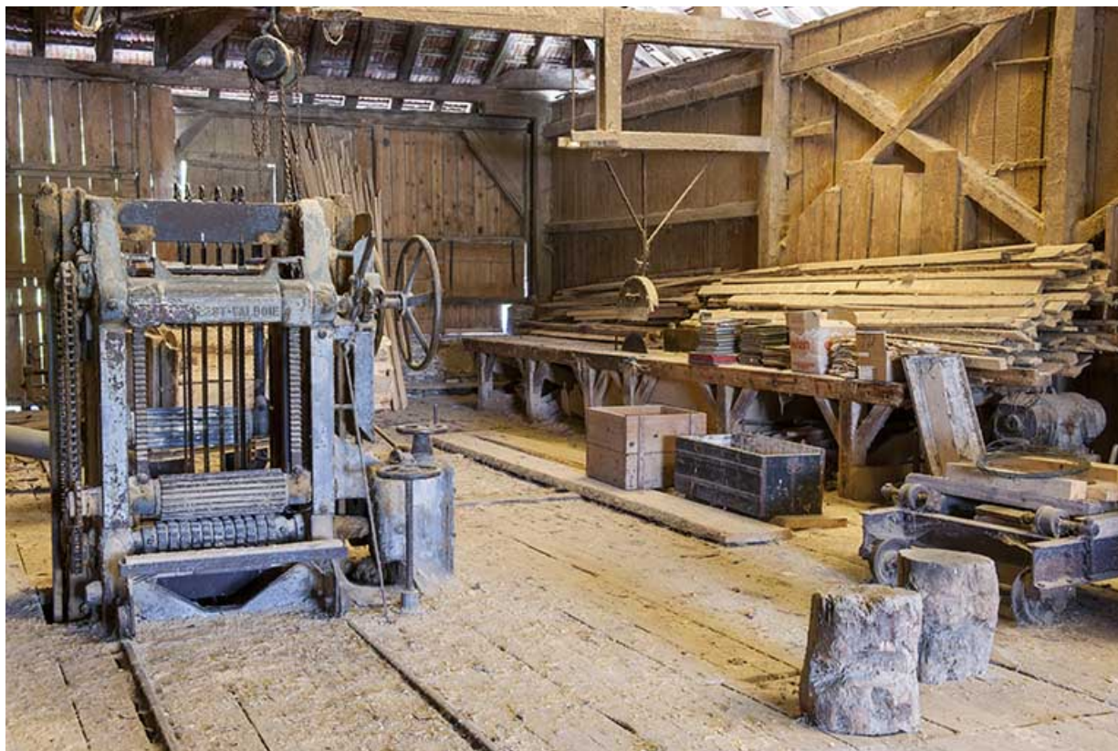
Châssis multilames Socolest et scie circulaire.
