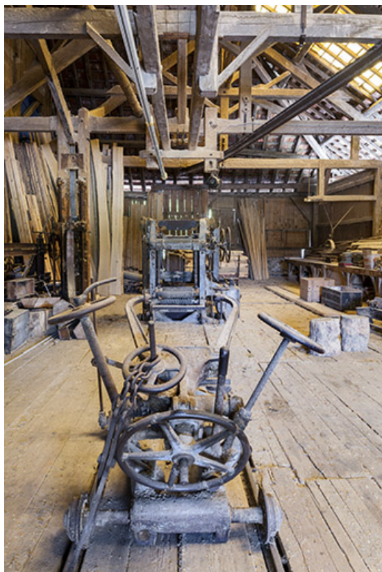
Châssis multilames et son chariot. Vue axiale.
