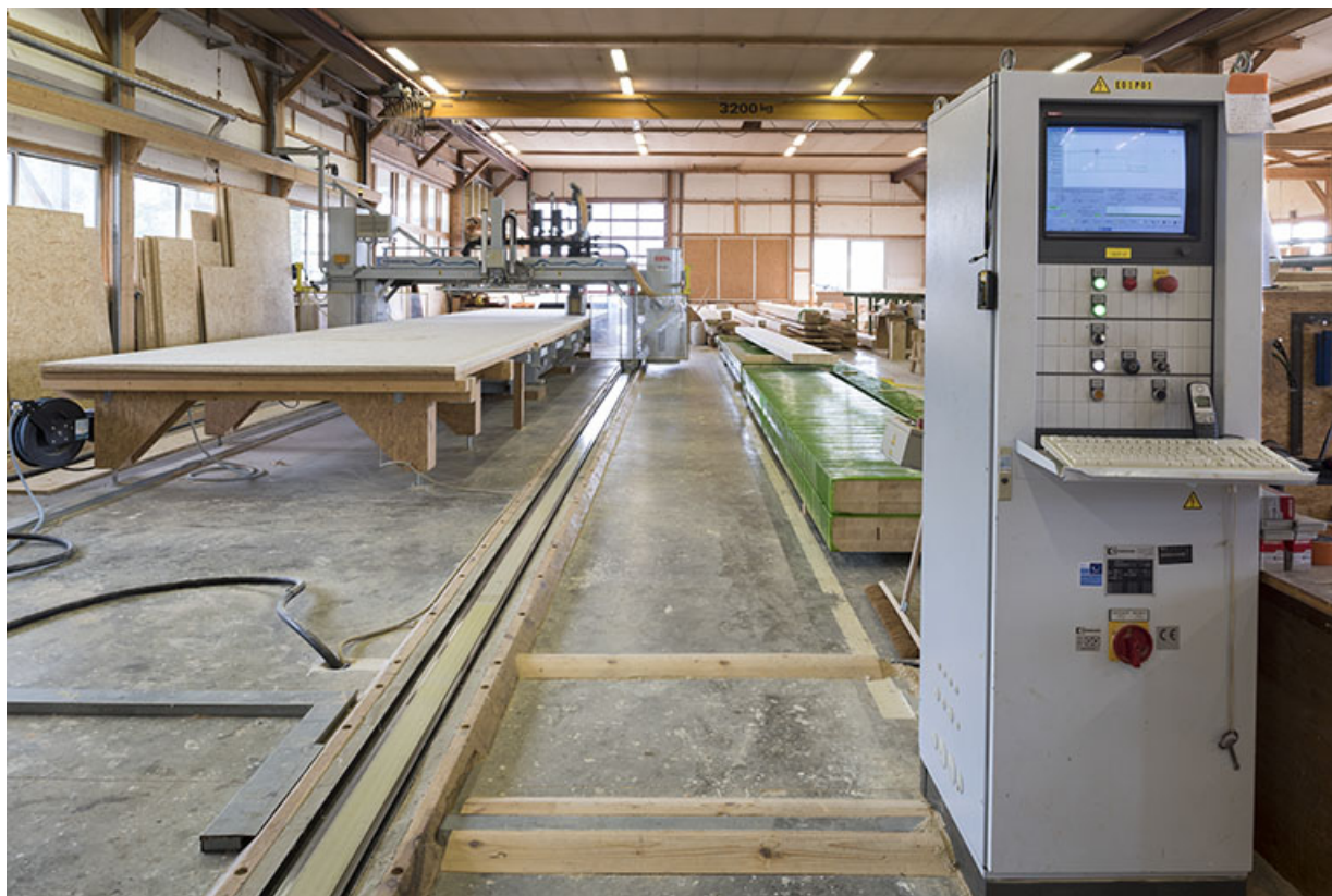
Nouveau site, atelier de fabrication : pont multifonctions à commandes numériques Weinmann WMS 150, côté pupitre de commandes.
