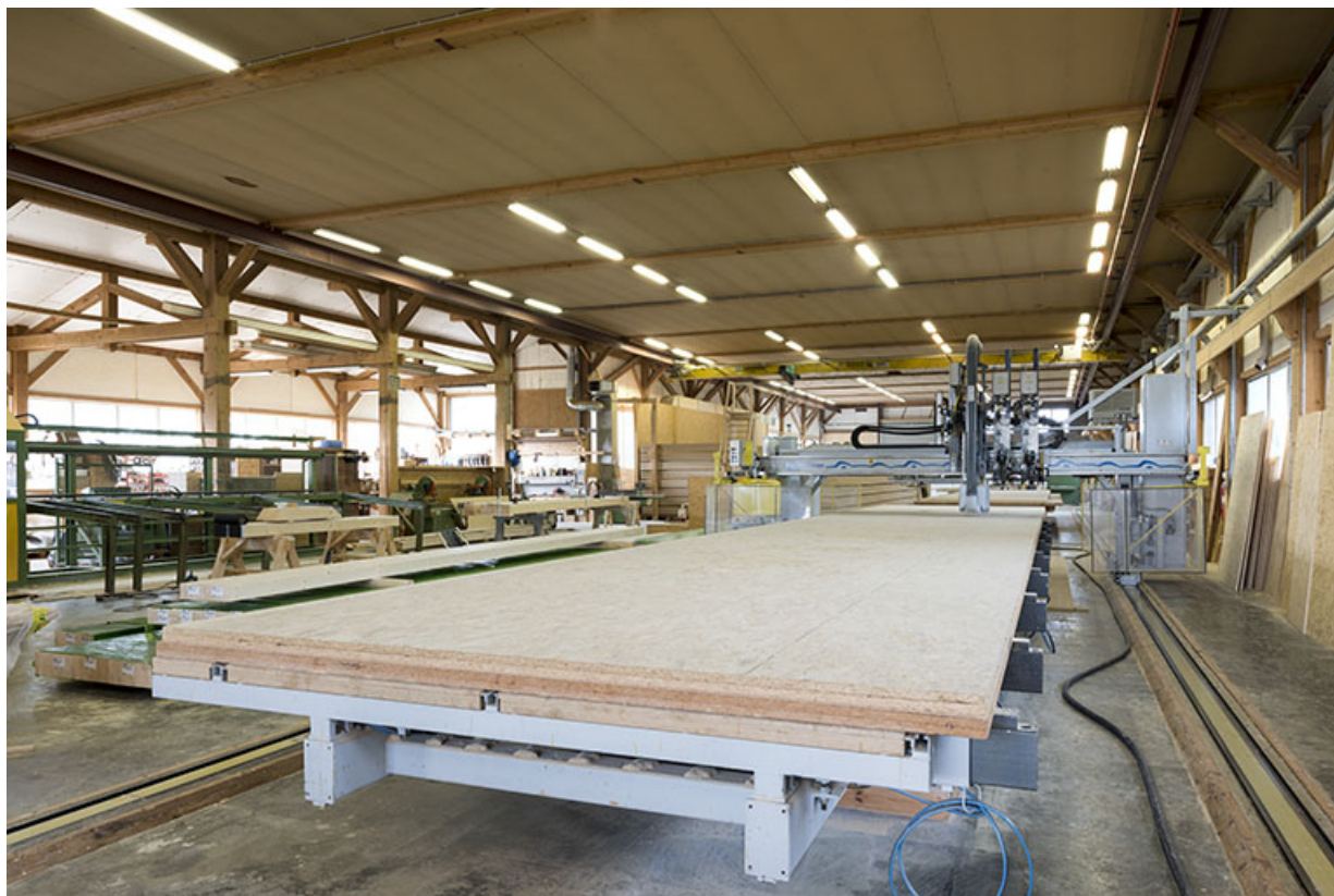
Nouveau site, atelier de fabrication : pont multifonctions à commandes numériques Weinmann WMS 150. 25, Villers-le-Lac rue Pierre Berçot, lieudit : les Terres rouges
