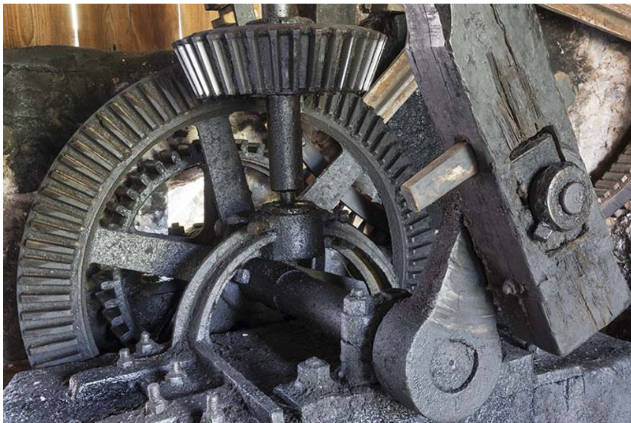
Mécanisme de transmission de la machine soufflante. Détail du système bielle-manivelle.
