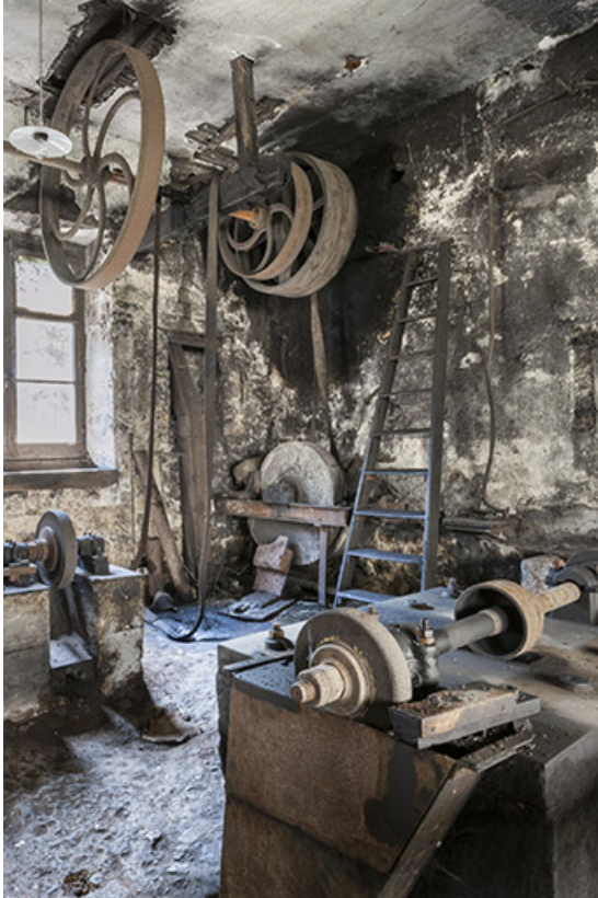
Atelier de mécanique. Transmission aérienne et polissoirs. 25, Nans-sous-Sainte-Anne rue du Four
