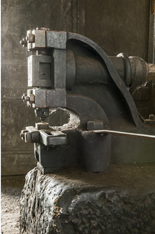
Atelier de mécanique. Poinçonneuse vue de côté. 25, Nans-sous-Sainte-Anne rue du Four
