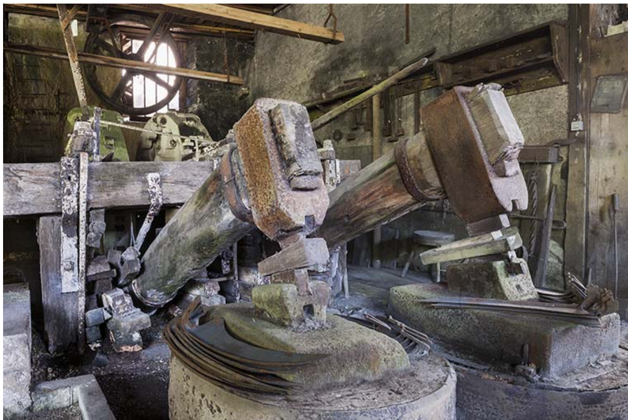
Les bras des martinets et leur bâti.
