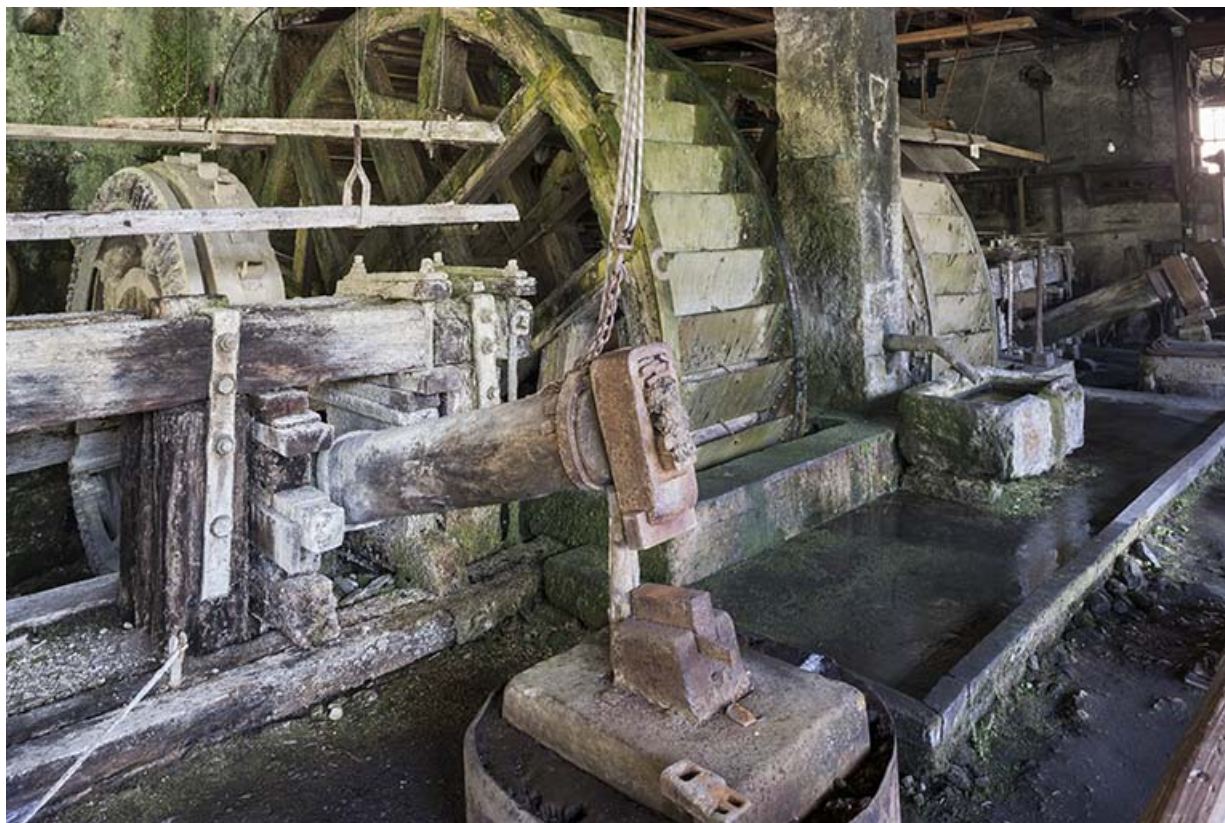
Les martinets et leurs roues motrices.
