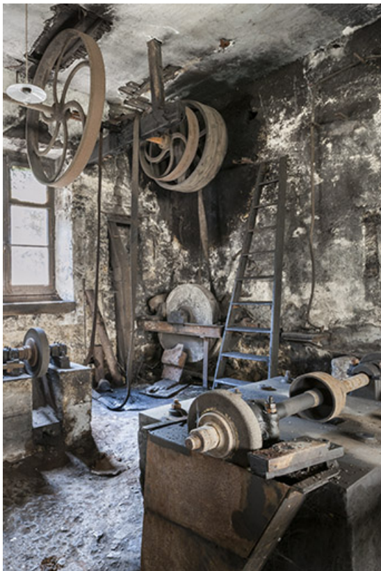
Atelier de mécanique. Transmission aérienne et polissoirs.
