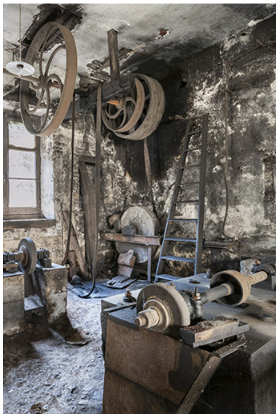
Atelier de mécanique. Transmission aérienne et polissoirs.
