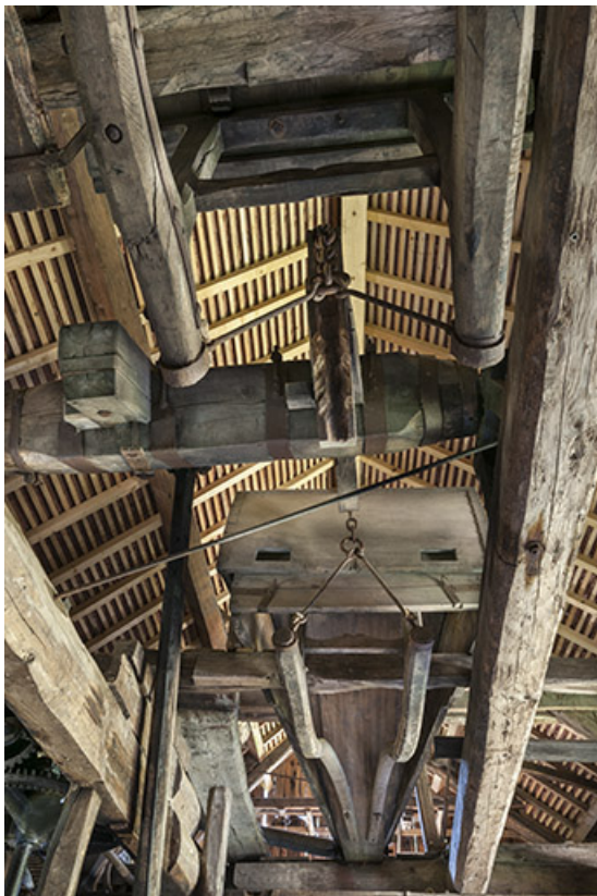
Mécanisme de bascule du soufflet double (caisson sud en position haute).
