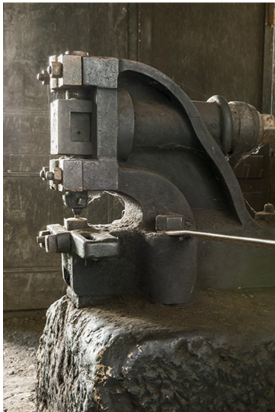
Atelier de mécanique. Poinçonneuse vue de côté.
