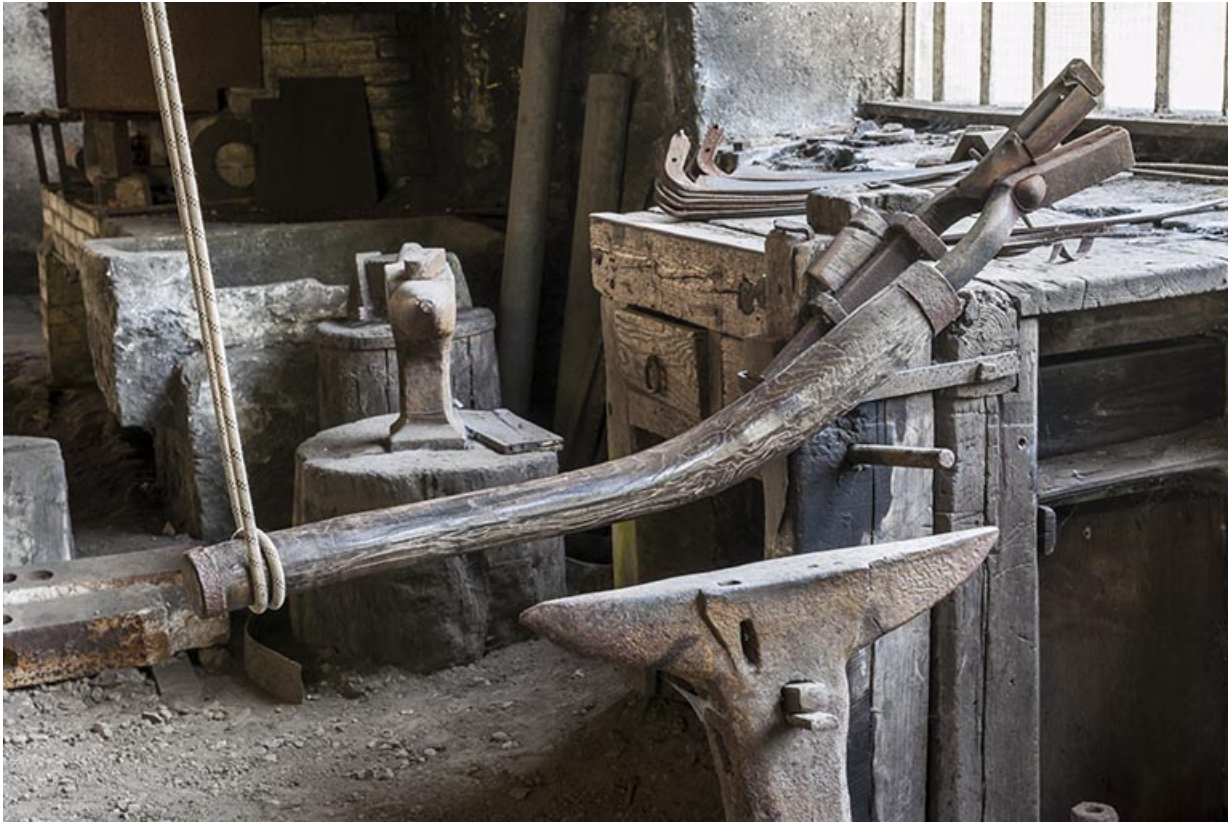
Cisaille de fabrication "maison". Reliée via une corde par une perche de noisetier fixée au plafond, elle est actionnée par le poids de l'ouvrier, assis en amazone sur le manche.
