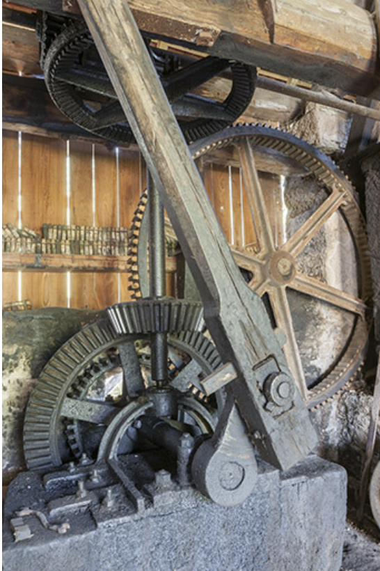
Mécanisme de transmission par bielle.
