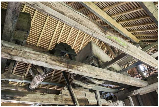
Pièce de la machine soufflante. Mécanisme de transmission et caisson sud.
