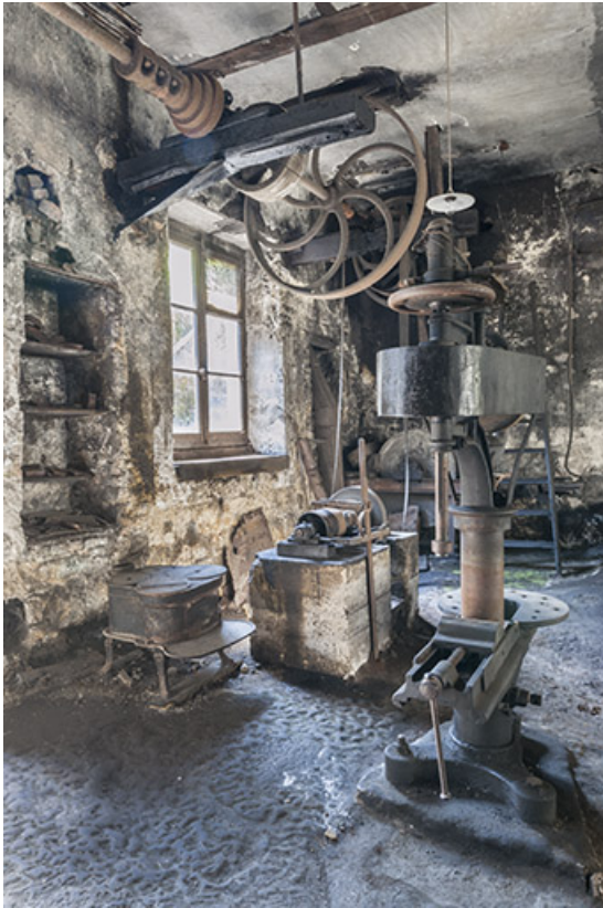
Atelier de mécanique : transmission aérienne, poêle, polissoir et perceuse à colonne. 25, Nans-sous-Sainte-Anne rue du Four
