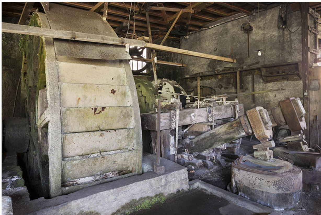
Roue hydraulique et les deux martinets ouest.
