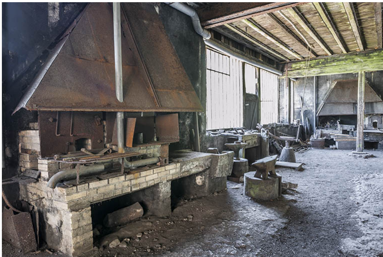
Feux de forge, enclumes et cisaille situés le long de la façade nord de l'atelier. 25, Nans-sous-Sainte-Anne rue du Four
