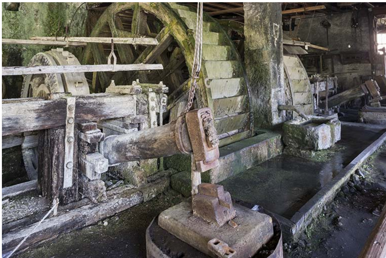
Les martinets et leurs roues motrices.
