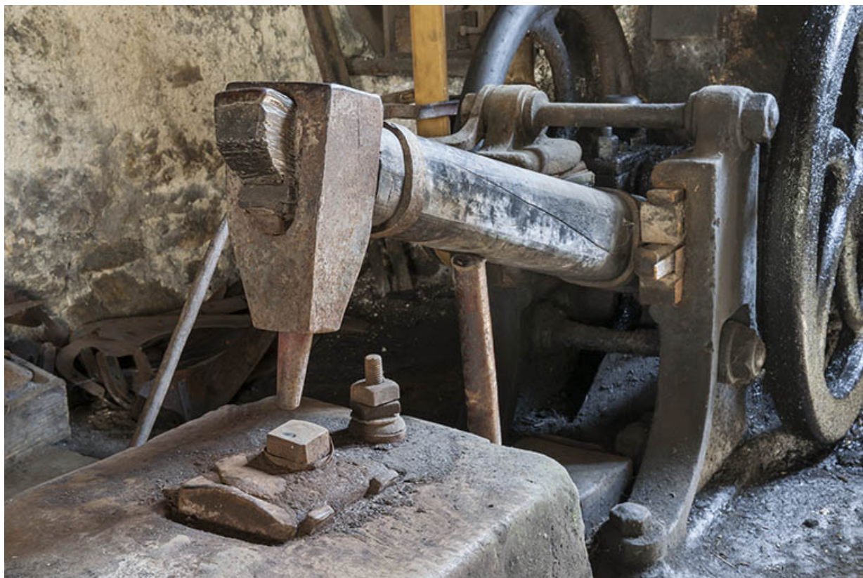
Atelier de mécanique. Détail de la tête du martinet de finition.
