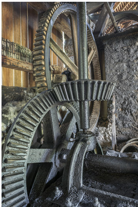
Machine soufflante. Détail des engrenages de la transmission.
