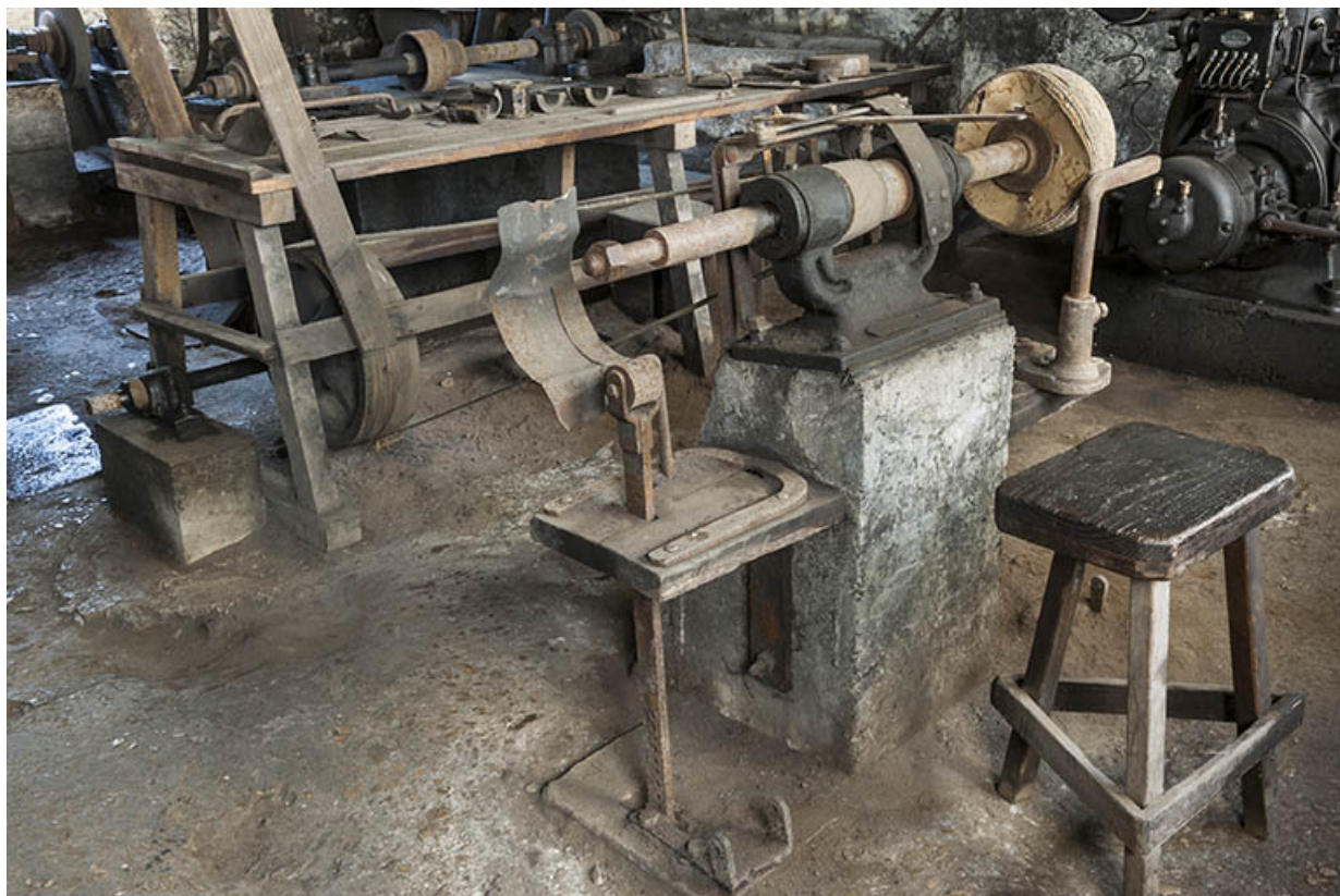
Atelier de mécanique. Poste de polissage.
