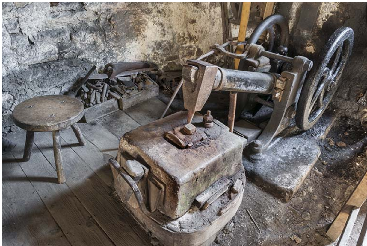
Atelier de mécanique. Martinet de finition. 25, Nans-sous-Sainte-Anne rue du Four
