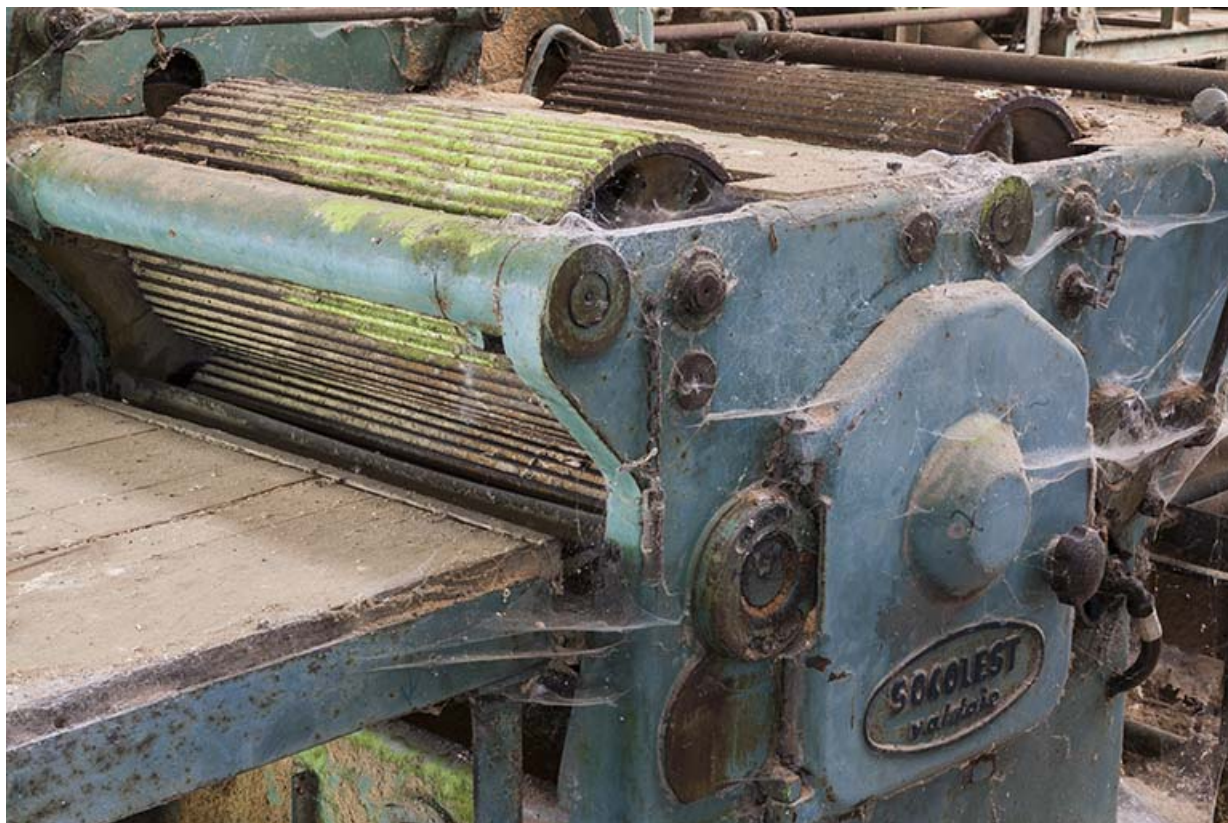
Déligneuse. Détail des rouleaux cannelés.
