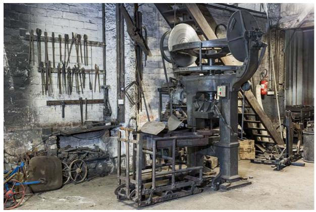
Balancier à friction (emboutissage des socs).
