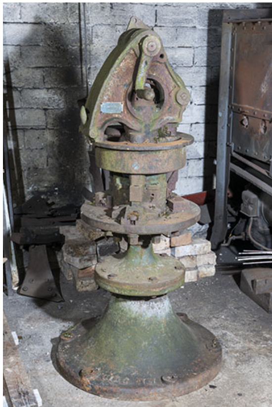
Machine Vernet (Dijon) à poinçonner et à découper. 25, Éternoz, 39 Grand Rue
