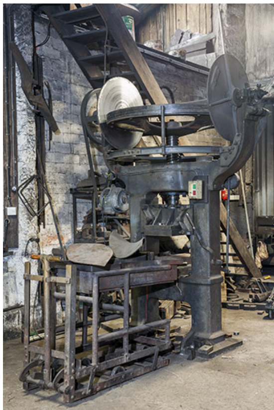
Balancier à friction et sa desserte.
