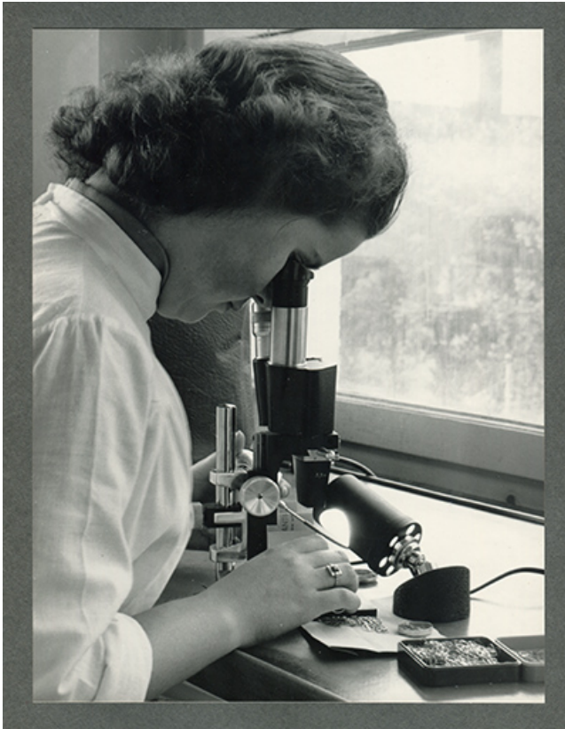
Ouvrière au travail : contrôle de balanciers, années 1960. 25, Villers-le-Lac, 5 rue Pierre Berçot
