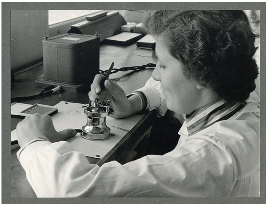
Ouvrière au travail : réglage du balancier-spiral, années 1960.
