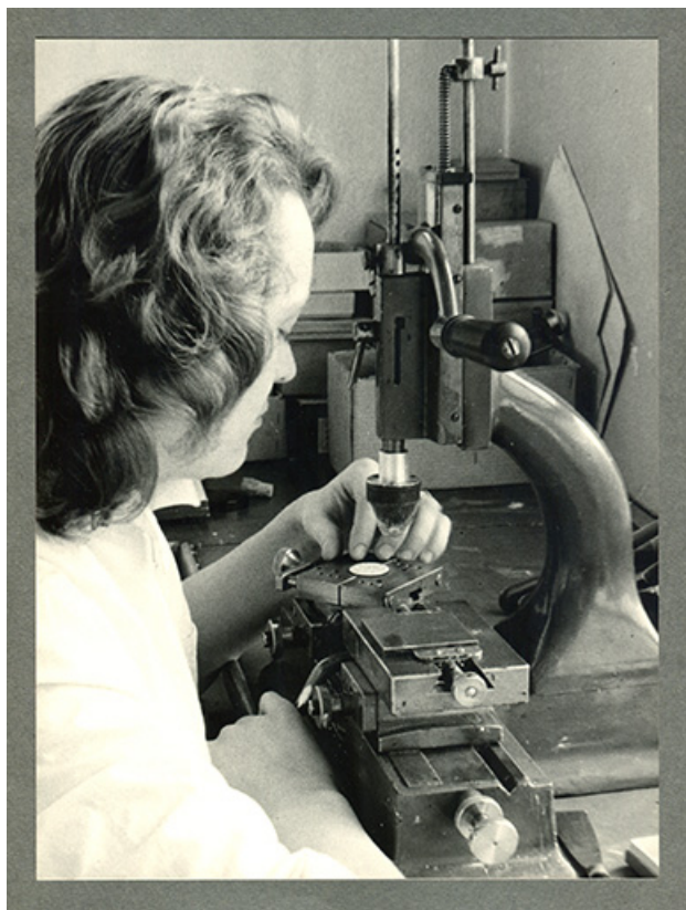
Ouvrière au travail : marquage du cadran, années 1960. 25, Villers-le-Lac, 5 rue Pierre Berçot
