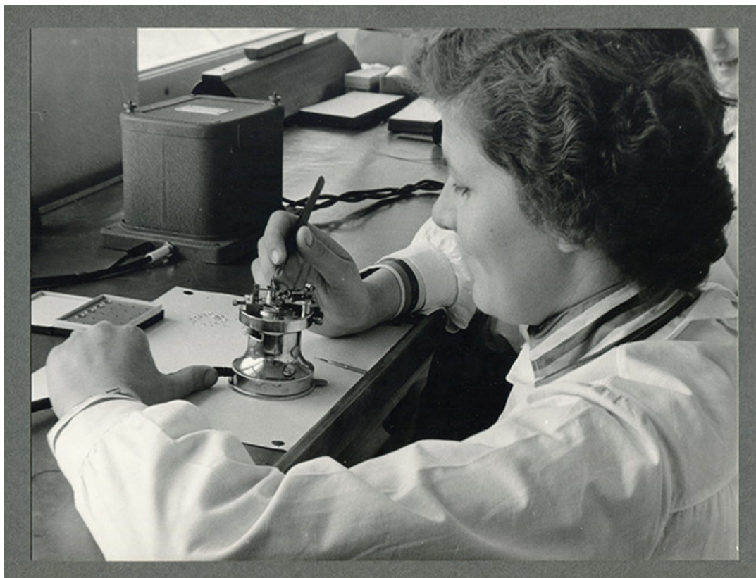
Ouvrière au travail : réglage du balancier-spiral, années 1960.
