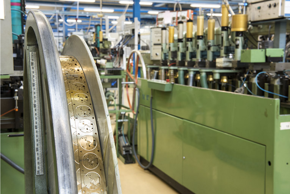
Atelier d'usinage : bande de laiton usinée.
