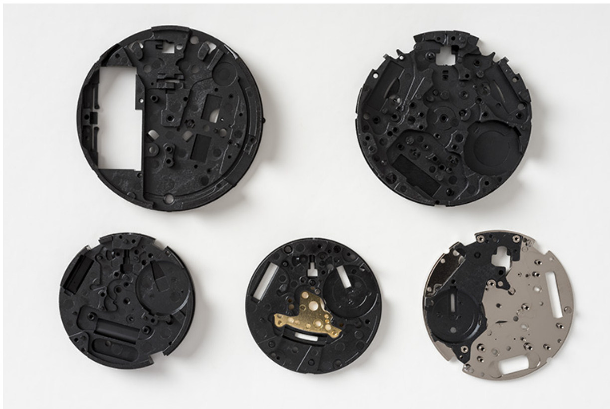
Composants fabriqués à l'usine : platines de montre alliant plastique et métal (face côté fond ?).
