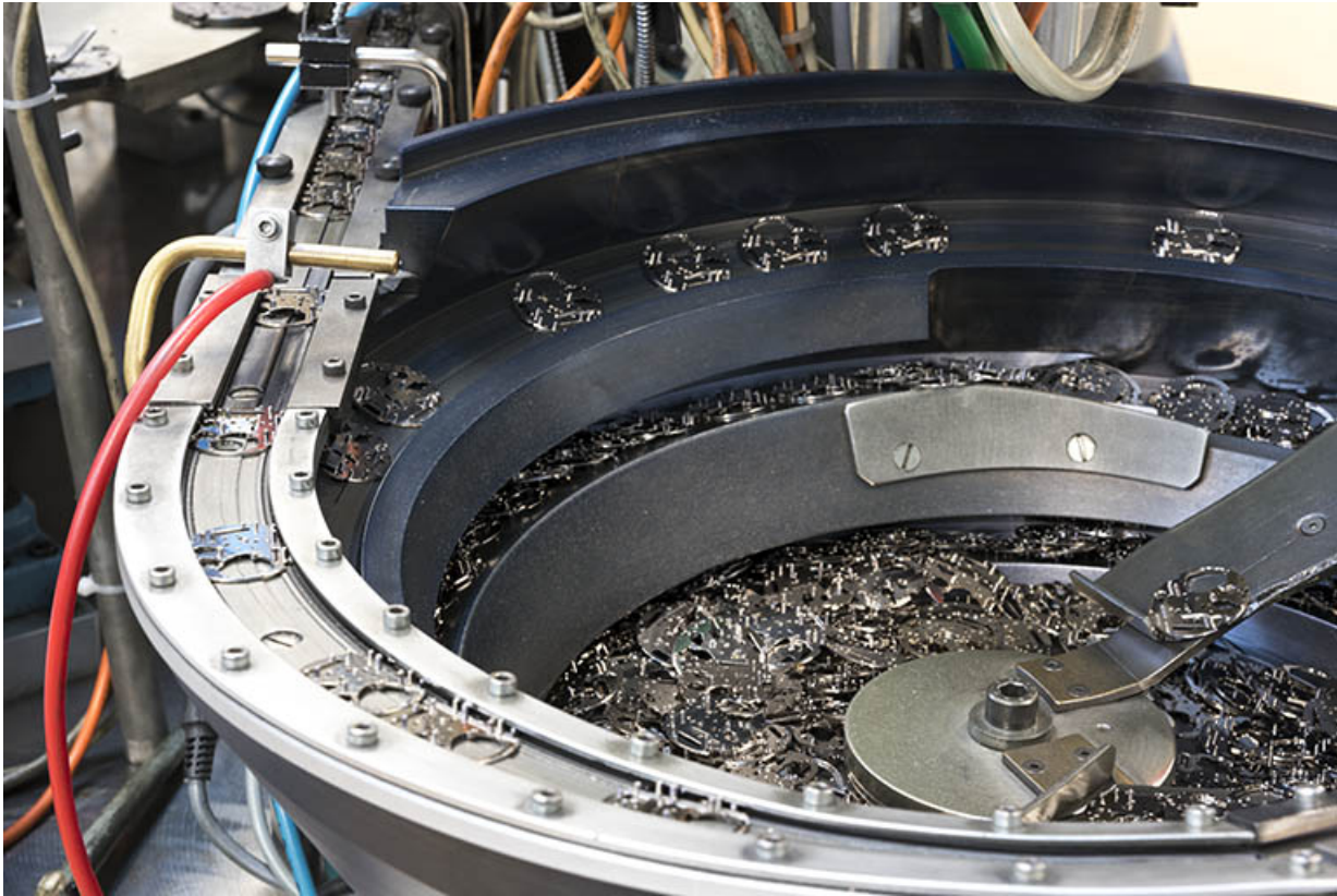
Atelier d'assemblage : détail du bol d'alimentation.
