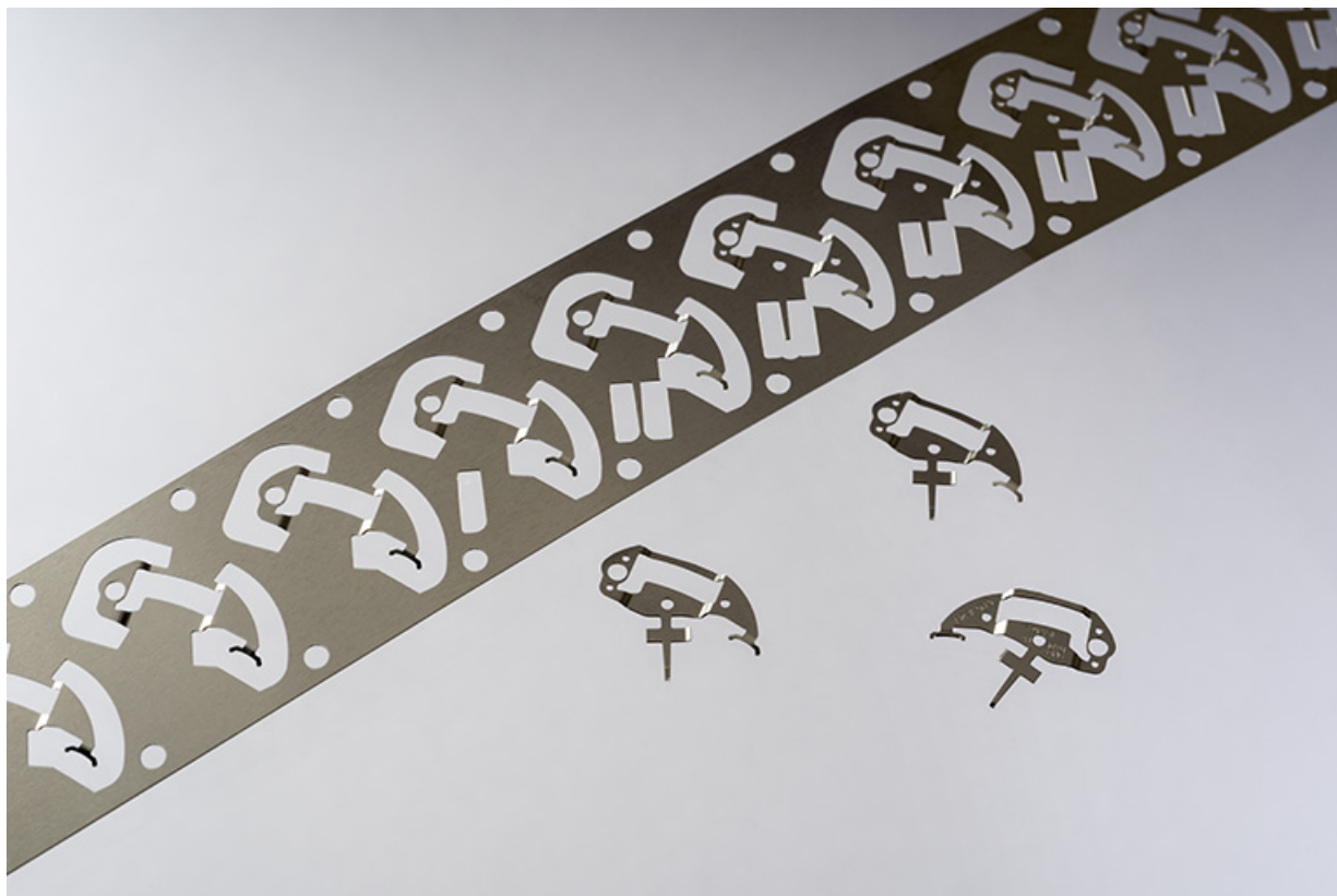
Exemple de composant et bande de matière, montrant les étapes successives de découpe à l'aide d'une étampe progressive. 25, Villers-le-Lac, 8 rue des Clos Rondot
