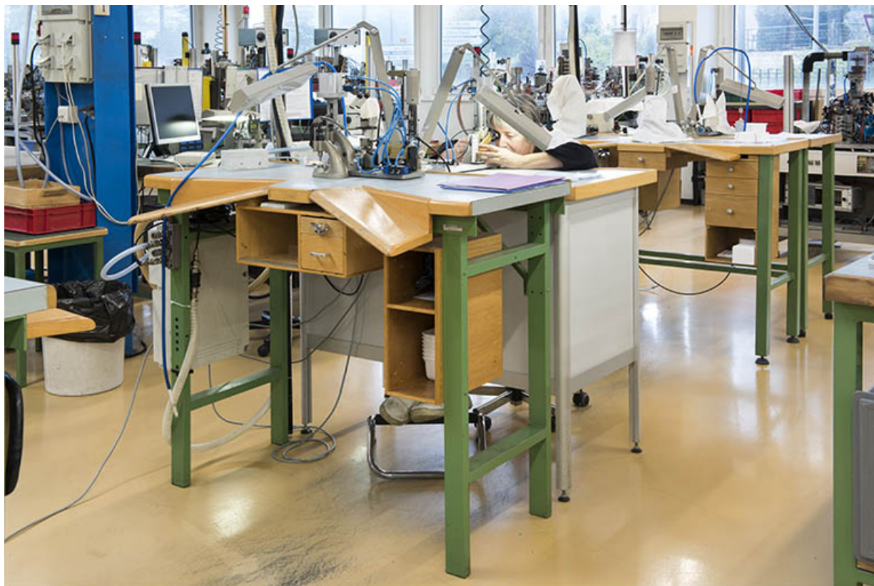
Atelier d'assemblage : poste d'assemblage manuel (éta bli d'horloger). 25, Villers-le-Lac, 8 rue des Clos Rondot
